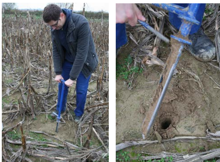
Slika 12 a i b. Uzimanje uzoraka tla nakon berbe kukuruza
