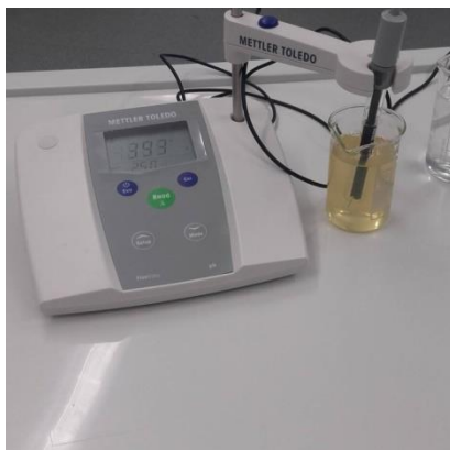
Slika 8. Mjerenje pH metrom
