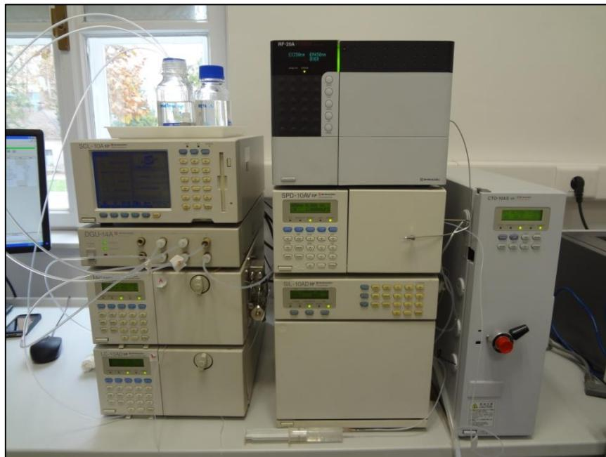
Slika 9. HPLC sustav Shimadzu (foto: M. Grčević, 2015.)
