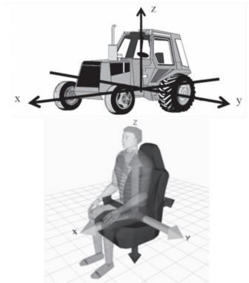
Slika 6. Definiranje ortogonalnih mjernih smjerova na traktor i rukovatelja
