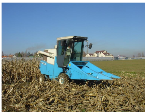
Slika 26. Kombajn za ubiranje kukuruza (Wintersteiger)
