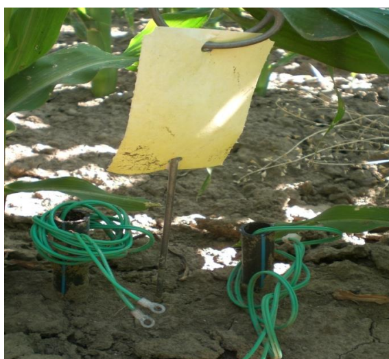
Slika 9. Elektrode Watermark senzora
