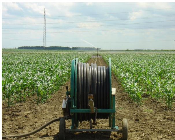
Slika 5. Pomicanje sustava prema koturu
