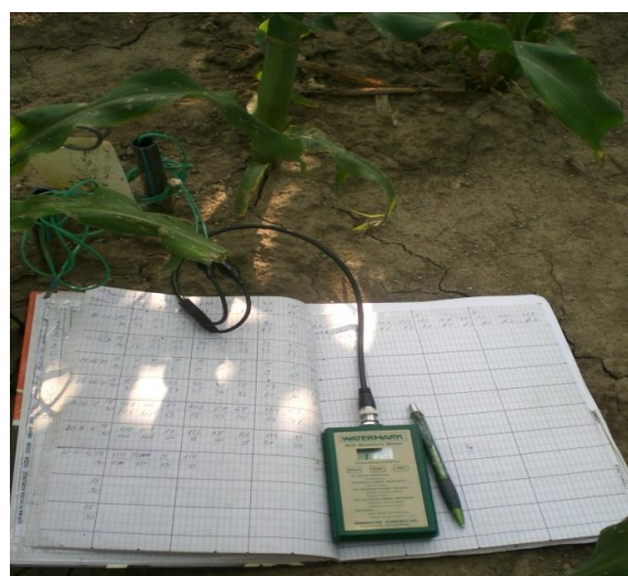
Slika 10. Očitavanje vrijednosti Watermark uređajem
