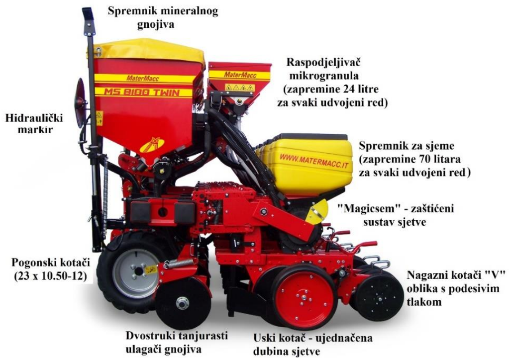
Slika 4. Glavni sustavi sijačice MaterMacc Twin Row-2 (Izvor: http://www.matermacc.it )
