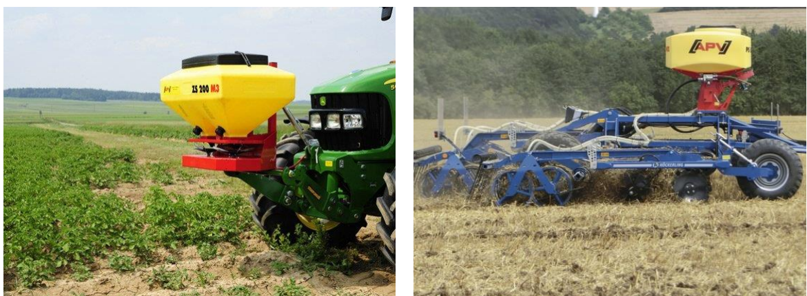
Slika 9. Uređaj za sjetvu siderata na prednjem podiznom uređaju (lijevo) i postavljeno na stroj u radu (desno) (Izvor: www.apv.at )
