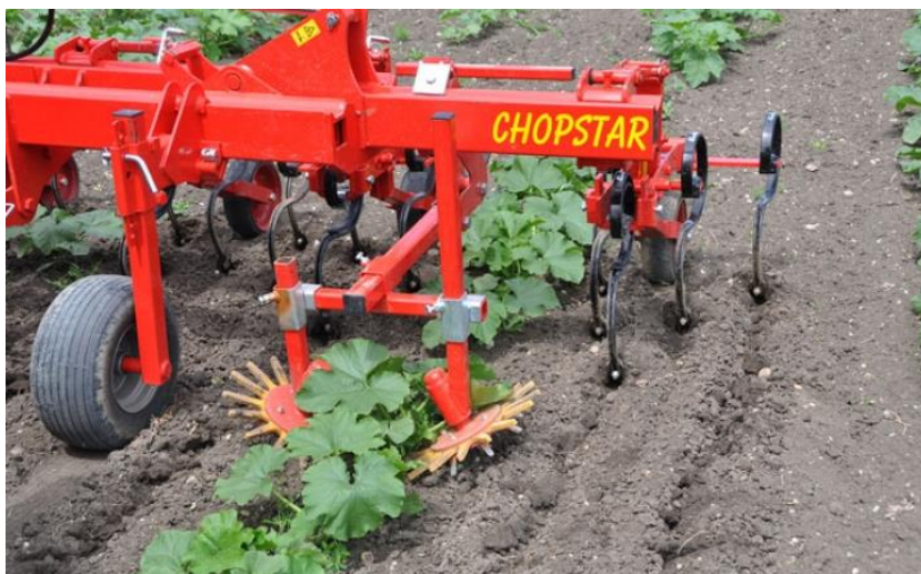
Slika 11. Kultivator za okopavine s rotirajućim zvjezadstim motikama (Izvor: www.einbock.at )
