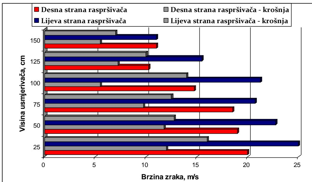
Grafikon 3. Vertikalna distribucija brzine zraka raspršivača *Hardi Zaturn* u nasadu jabuke
