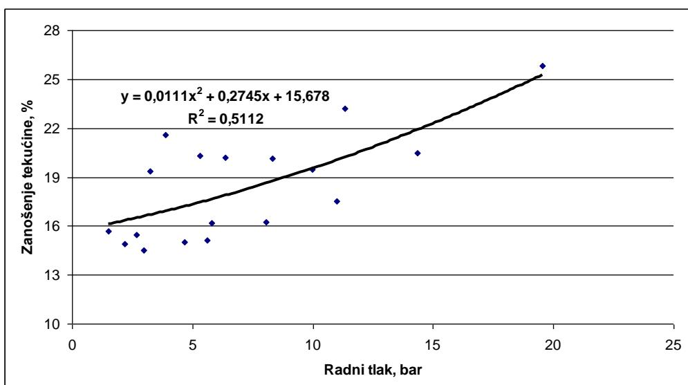
Grafikon 22. Utjecaj radnog tlaka na zanošenje tekućine
