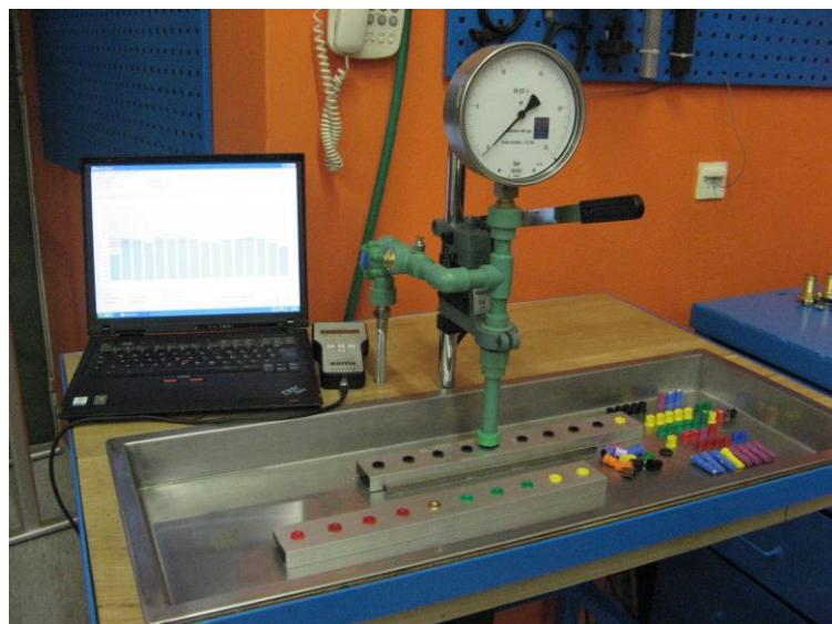
Slika 12. Stolno – elektronski uređaj za mjerenje protoka mlaznica
