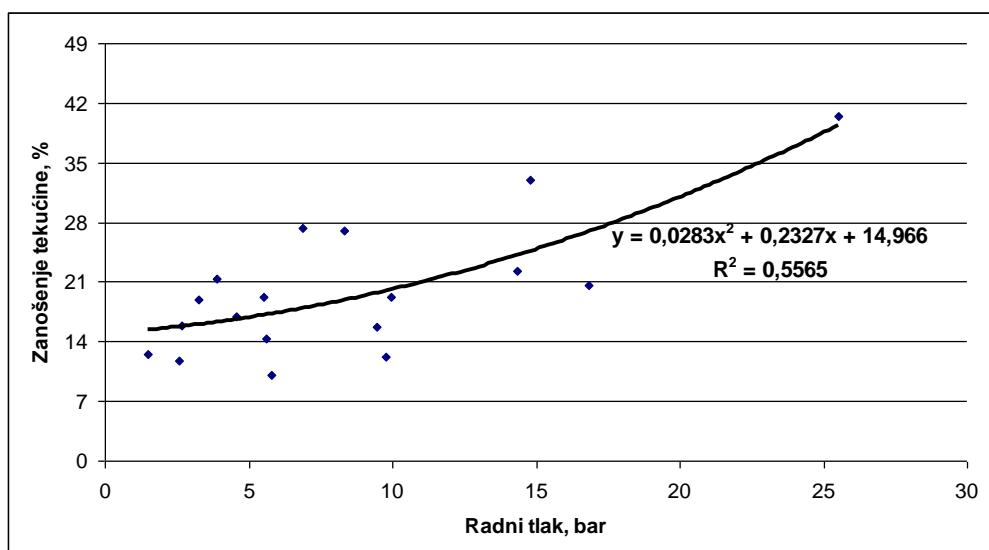
Grafikon 46. Utjecaj radnog tlaka na zanošenje tekućine
