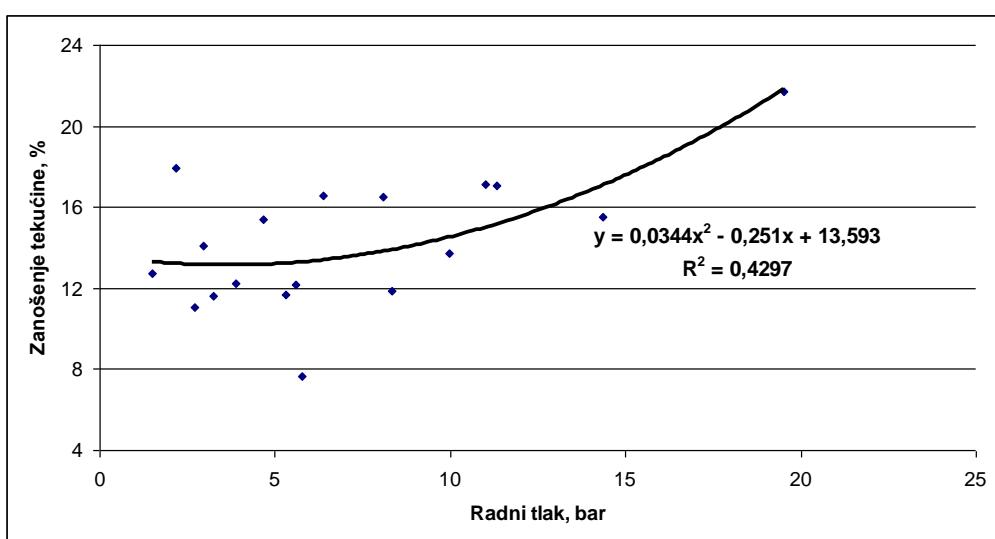
Grafikon 32. Utjecaj radnog tlaka na zanošenje tekućine
