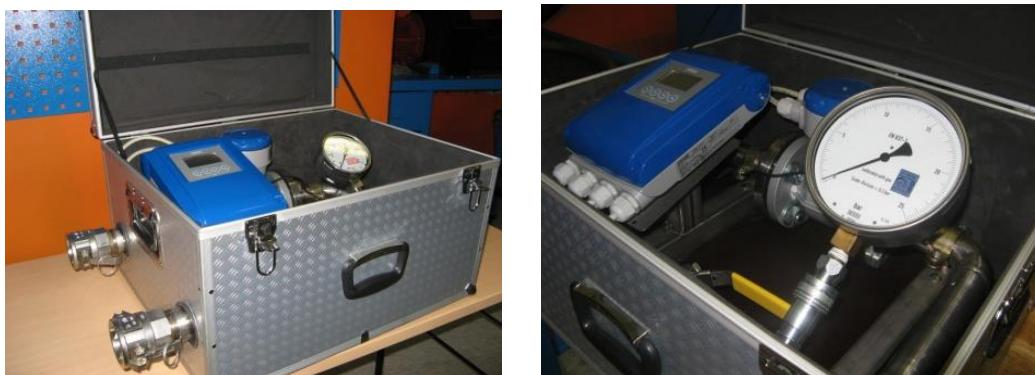
Slika 10. Elektromagnetski mjerač protoka crpke tvrtke *Krohne*
