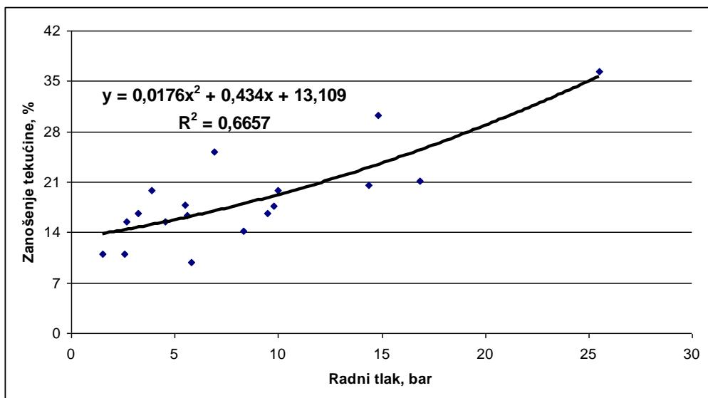
Grafikon 56. Utjecaj radnog tlaka na zanošenje tekućine
