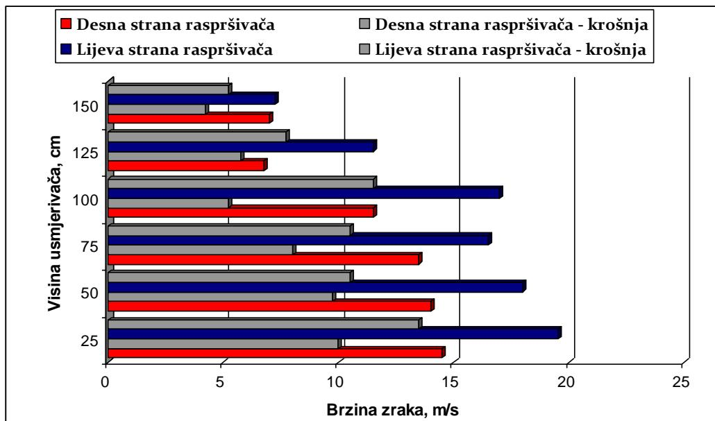
Grafikon 2. Vertikalna distribucija brzine zraka raspršivača *Hardi Zturn* u vinogradu
