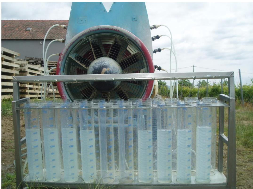
Slika 13. Uređaj *Volos 2* za mjerjenje protoka mlaznica
