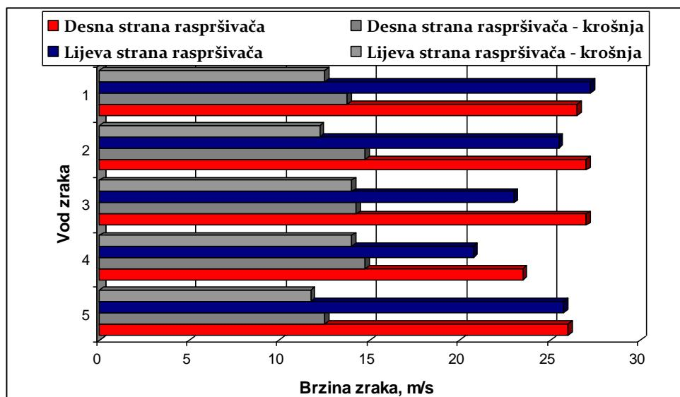
Grafikon 5. Vertikalna distribucija brzine zraka raspršivača *Hardi Arrow* u nasadu jabuke
