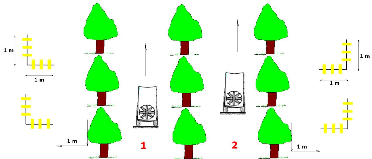
Slika 27. Shema postavljanja vodoosjetljivih papirića za mjerjenje zanošenja
