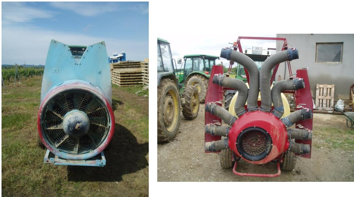
Slika 6. Sustav istrujavanja zraka (*Hardi Zaturn* lijevo i *Hardi Arrow* desno)
