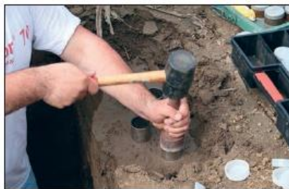
Slika 6. Uzorkovanje tla u prirodnom nenarušenom stanju u cilindre Kopecki (Izvor: autor prema Lončarić i sur., 2014. )
