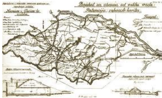
Slika 3. Projekt melioracijskih zahvata prof. Belle u slivu Karašice i Vučice ( http://www.casopis-gradjevinar.hr/assets/Uploads/JCE_66_2014_2_7_Vu%C4%8Dica.pdf )
