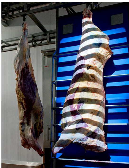
Slika 4. Postupak ocjene goveđih trupova VIA sustavom
