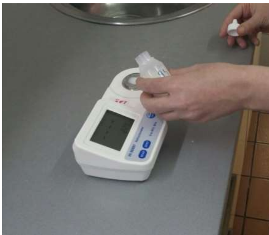
Slika 15. Analiza uzorka kolostruma krmače pomoću HANNA HI 96801 refraktometra
