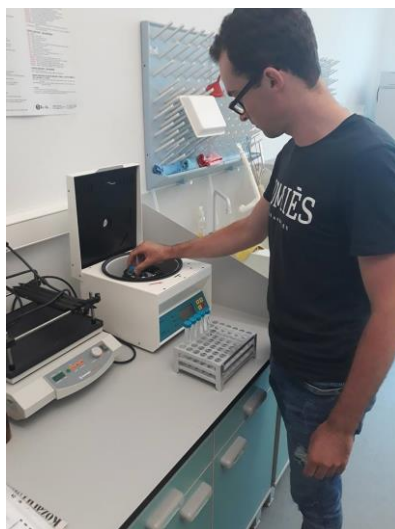
Slika 6. Postavljanje Falcon tubica u centrifugu
