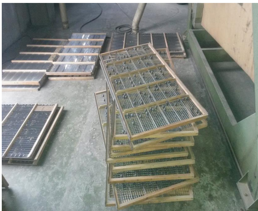
Slika 16. Sita uređaja za čišćenje (Izvor: vlastita fotografija)
