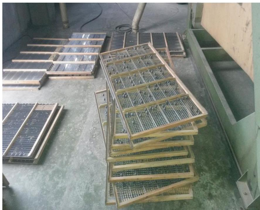
Slika 16. Sita uređaja za čišćenje (Izvor: vlastita fotografija)
