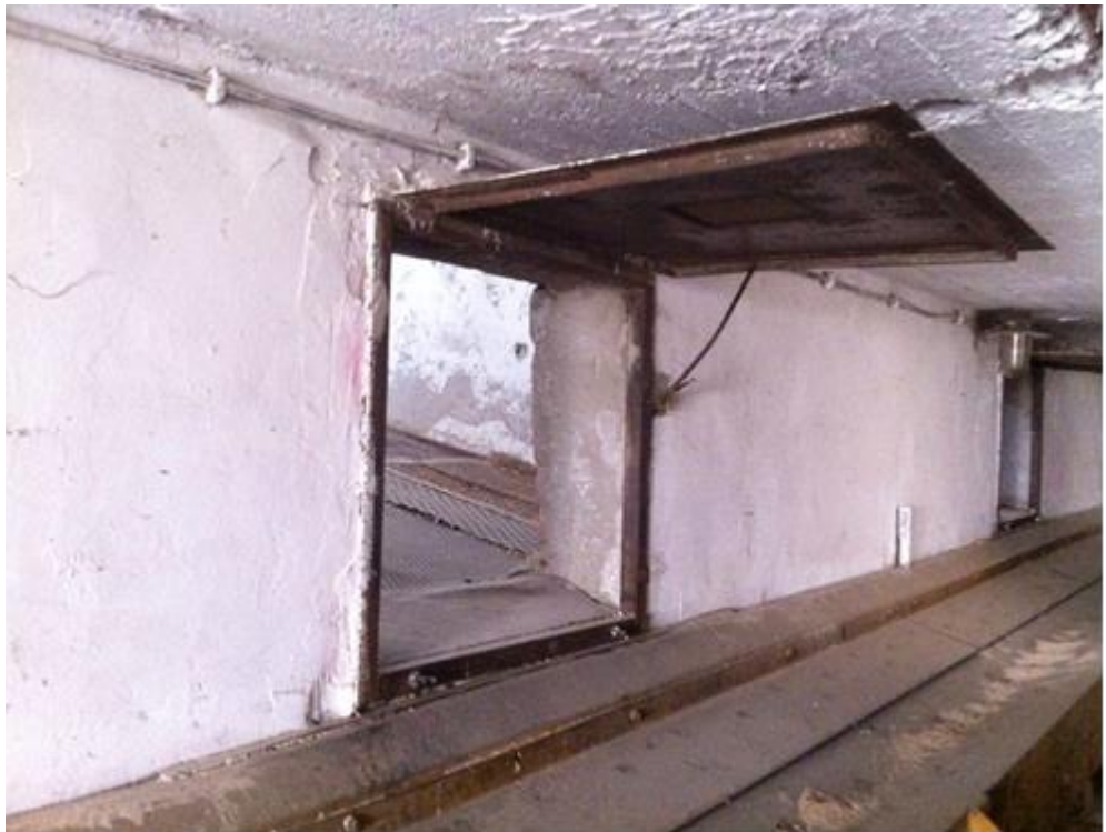
Slika 12. Trakasti transporter za pražnjenje komora sušenja (Izvor: vlastita fotografija)
