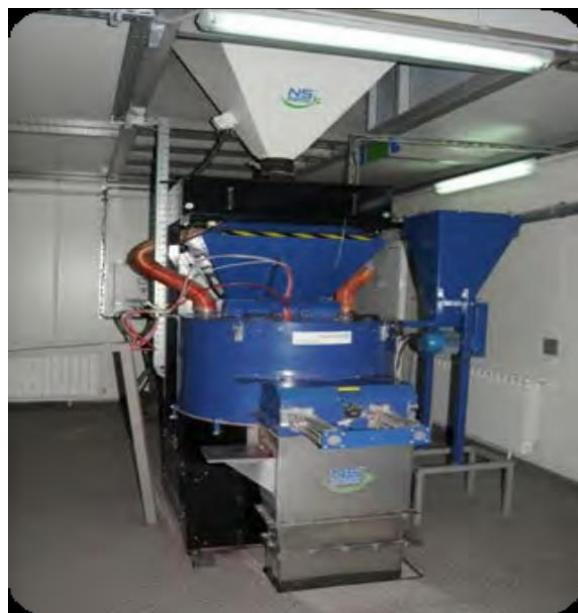
Slika 19. Centrifugalni zapršivač (Izvor: vlastita fotografija)
