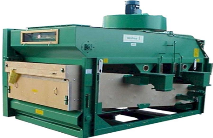
Slika 15. Uređaj za čišćenje zrna kukuruza (Izvor: vlastita fotografija)
