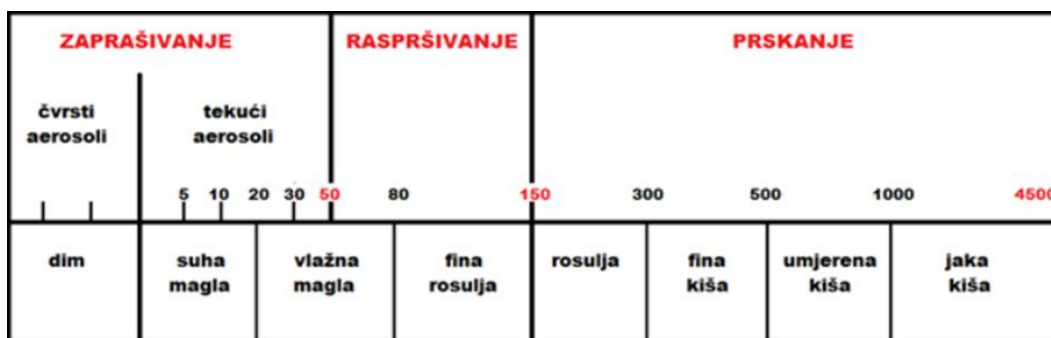
Slika 57. Shematska prikaz usporedbe veličina čestica – µm
