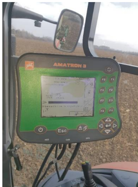
Slika 62. AMATRON 3 upravljački terminal (Izvor: Autor)
