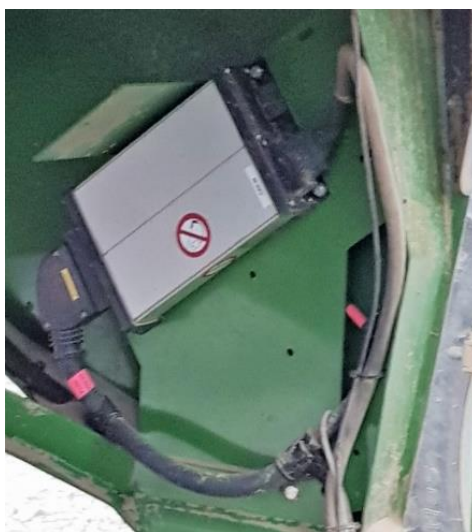
Slika 57. ISOBUS modul sijačice (Izvor: Autor)
