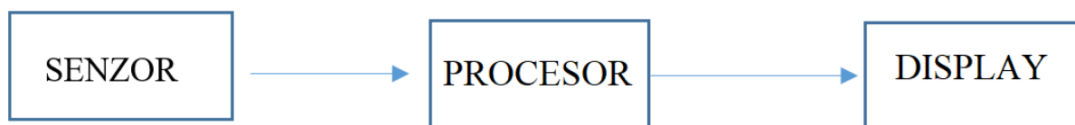
Slika 1. Shematski prikaz tri osnovna dijela mjernih pretvarača
