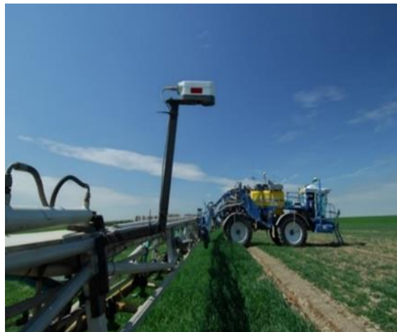
Slika 38. Ag Leader OptRx senzor postavljen na krila samohodne prskalice
