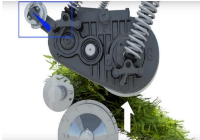
Slika 65. Uvlačno grlo silo kombajna sa senzorom prinosa u plavom kvadratiću (Izvor: https://www.youtube.com/user/NewHollandAG )
