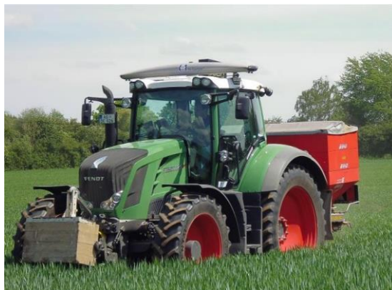
Slika 40. Yara dušični senzori postavljeni na kabinu traktora
