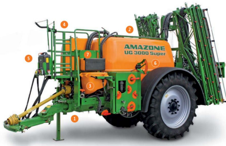
Slika 60. Konstrukcija prskalice Amazone UG 3000 (Izvor: http://et.amazone.de/files/pdf/mg3506.pdf )
