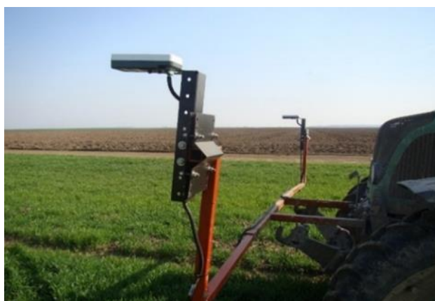
Slika 26. Način postavljenja OptRx senzora na traktor Fendt 716 Vario Belje d.d. (Izvor: Marić, 2015)
