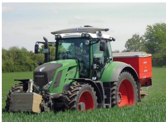
Slika 40. Yara dušični senzori postavljeni na kabinu traktora
