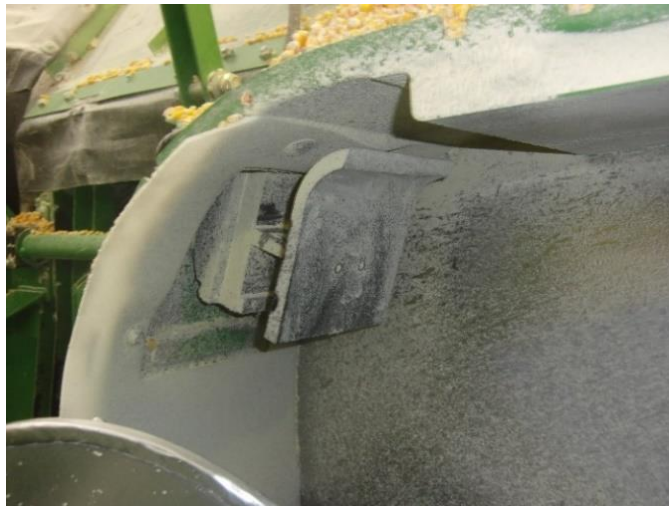
Slika 69. Senzor udara – protoka mase u eksploatacijskim uvjetima
