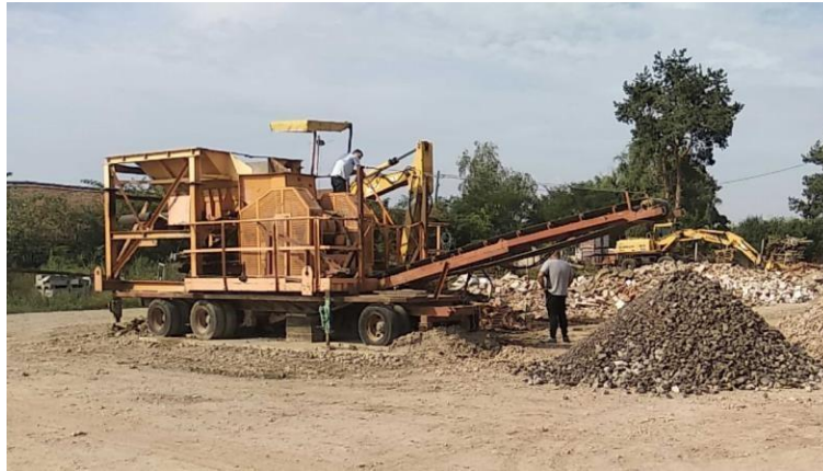
Slika 3. Drobilica građevinskih materijala
