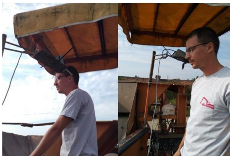
Slika 9. Položaj mikrofona pri mjerenju
