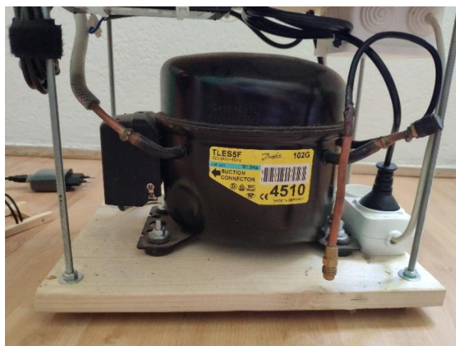
Slika 13. Vakuum crpka-kompresor, zadnja strana
