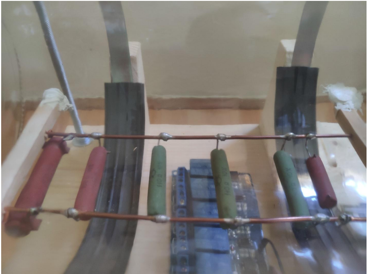
Slika 17. Grijači (žičani otpornici)
