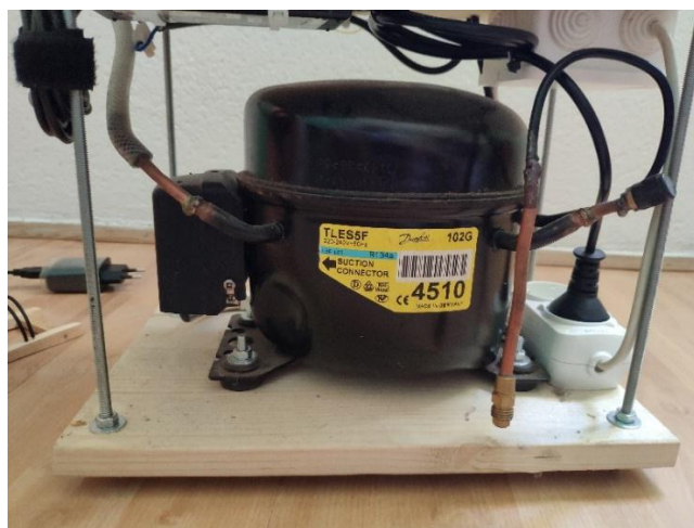
Slika 13. Vakuum crpka-kompresor, zadnja strana
