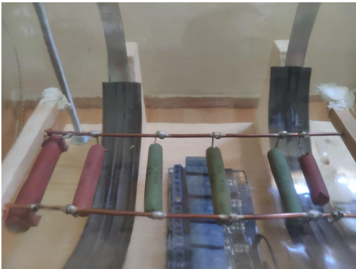
Slika 17. Grijači (žičani otpornici)
