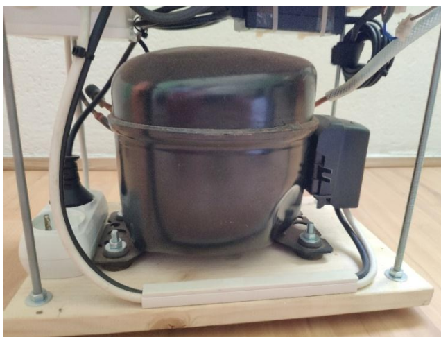
Slika 12. Vakuum crpka-kompresor, prednja strana
