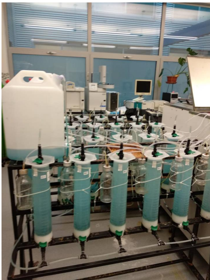
Slika 10. Provedba procesa anaerobne fermentacije
