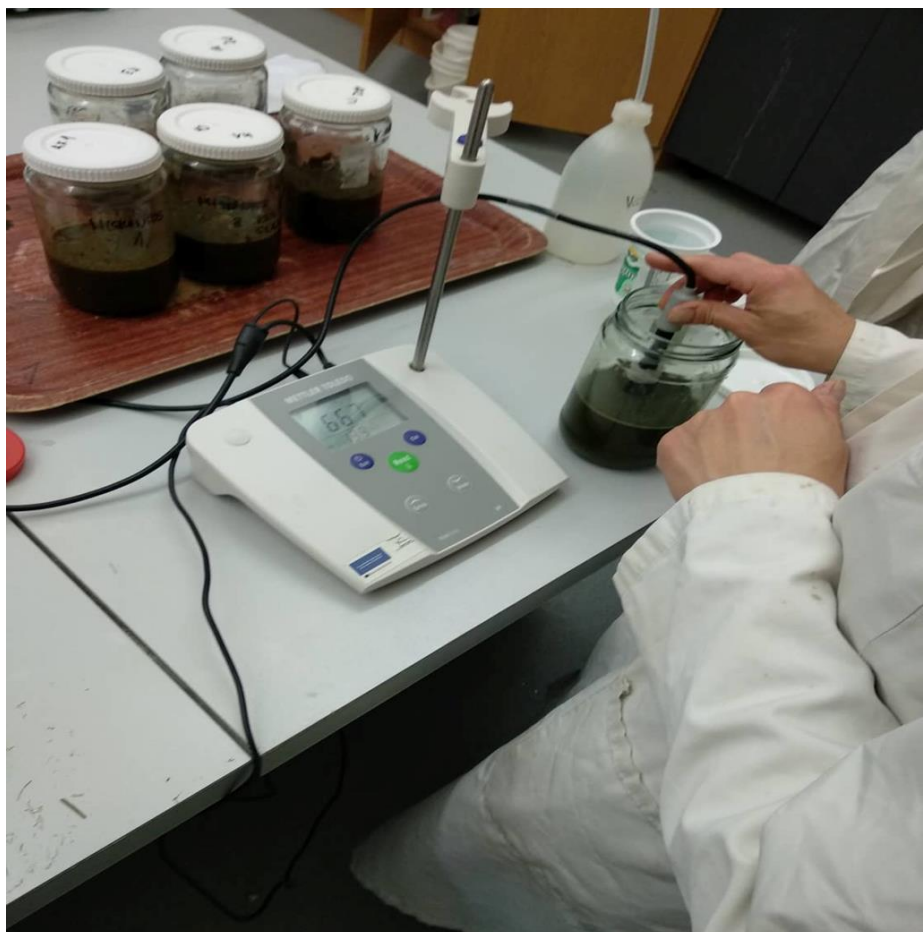
Slika 11. Ispitivanje koncentracije pH
