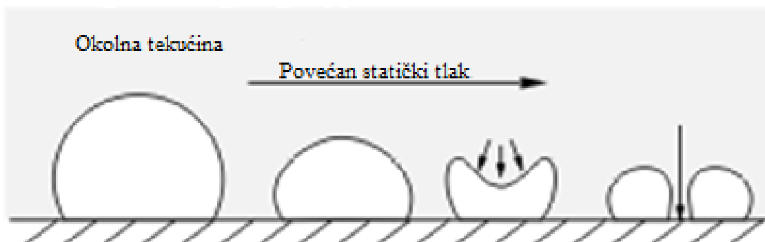
Slika 16. Shema kavitacijskog trošenja (Izvor: https://en.wikipedia.org/wiki/Cavitation#/media/File:Cavitation_bubble_implosion.png )
