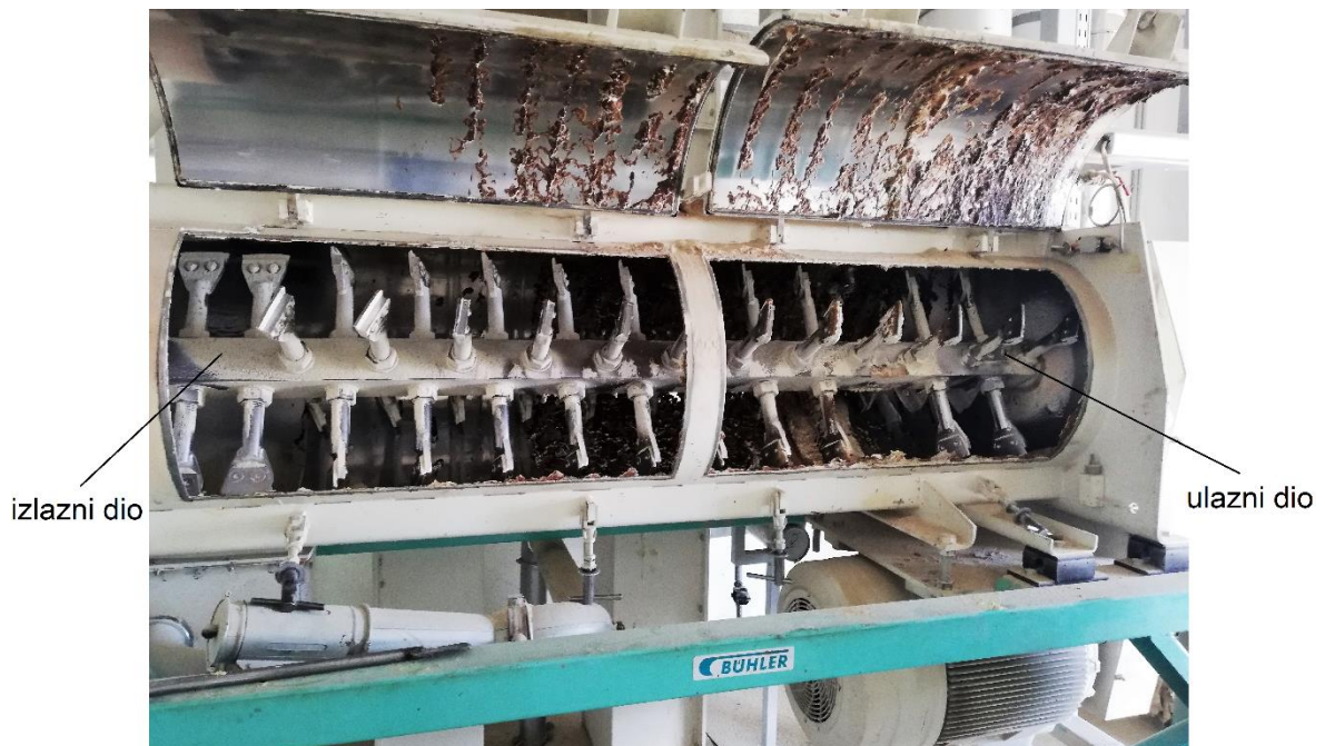
Slika 35. Otvoreni radni prostor homogenizatora (Fotografija: Janješić, 2019.)
