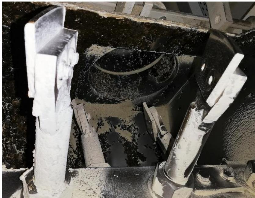
Slika 36. Lopatice na ulaznom otvoru homogenizatora (Fotografija: Janješić, 2019.)
