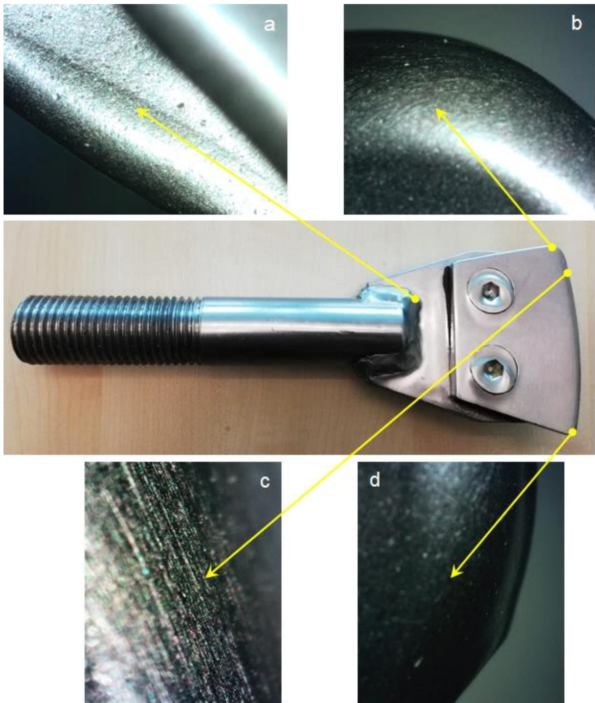
Slika 38. Prikaz oblika trošenja na lopaticama homogenizatora
