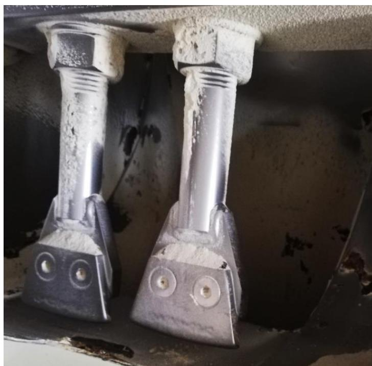
Slika 37. Lopatice na izlaznom otvoru homogenizatora (Fotografija: Janješić, 2019.)
