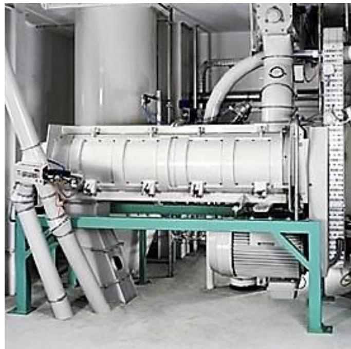
Slika 22. Homogenizator DPSD
