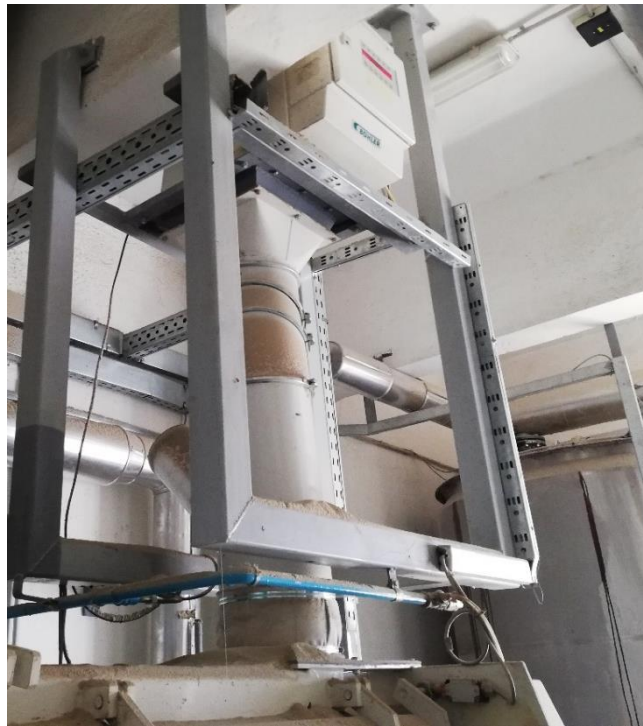
Slika 27. Cijev za dovod krutog sastava smjese do homogenizatora (Fotografija: Janješić, 2019.)
