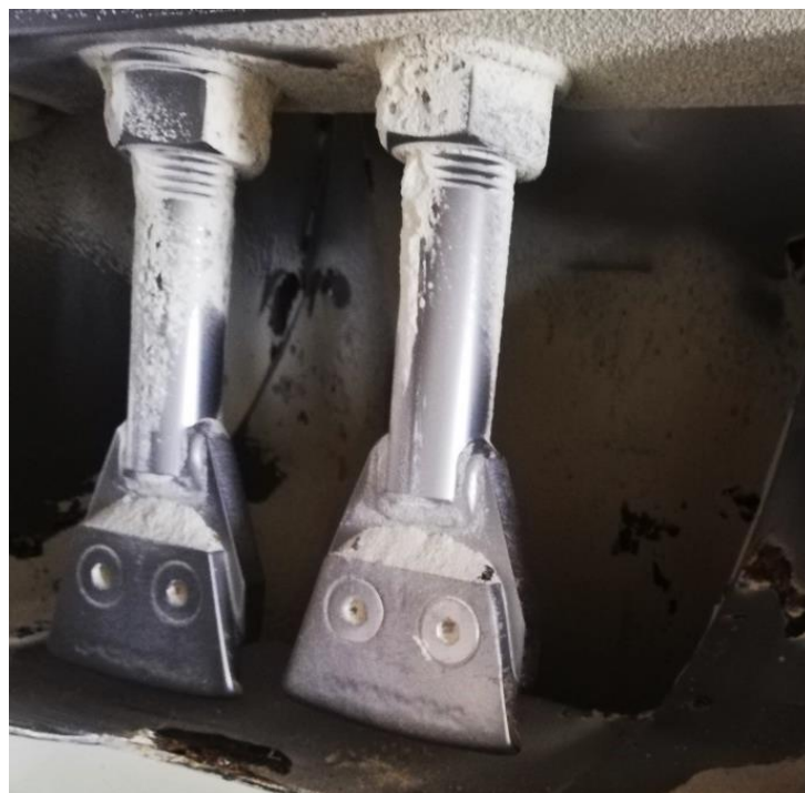
Slika 37. Lopatice na izlaznom otvoru homogenizatora (Fotografija: Janješić, 2019.)
