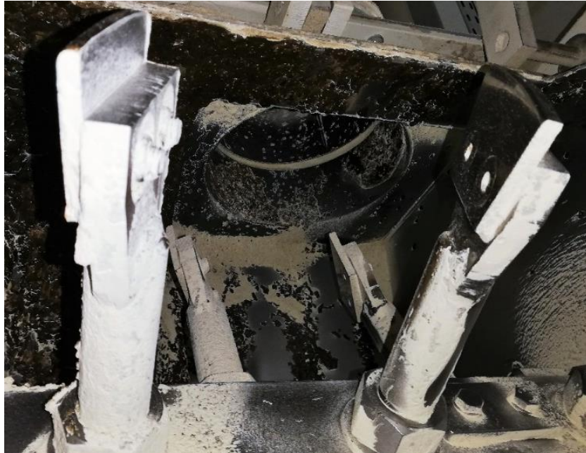
Slika 36. Lopatice na ulaznom otvoru homogenizatora (Fotografija: Janješić, 2019.)
