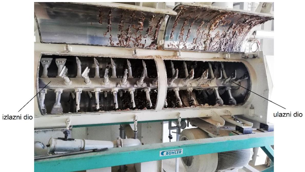
Slika 35. Otvoreni radni prostor homogenizatora (Fotografija: Janješić, 2019.)
