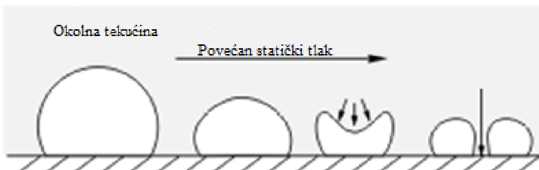
Slika 16. Shema kavitacijskog trošenja (Izvor: https://en.wikipedia.org/wiki/Cavitation#/media/File:Cavitation_bubble_implosion.png )
