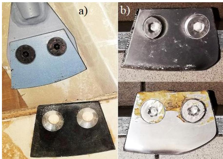
Slika 33. Lopatice homogenizatora, nove (a) i iskorištene (b) (Fotografija: Janješić, 2019.)
