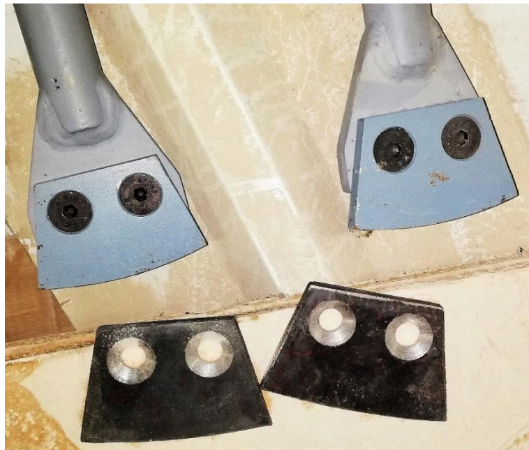
Slika 31. Lopatice homogenizatora (Fotografija: Janješić, 2019.)
