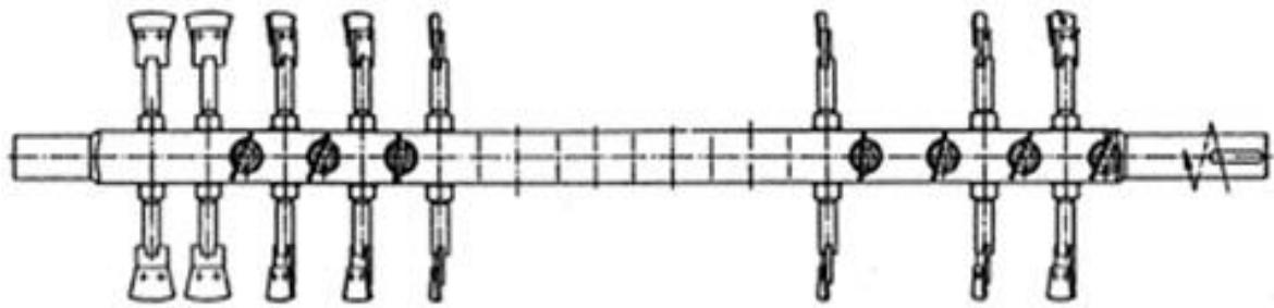
Slika 26. Shema radnih dijelova homogenizatora (Izvor: Bühler, 1998.)
