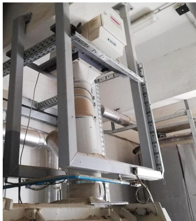
Slika 27. Cijev za dovod krutog sastava smjese do homogenizatora
