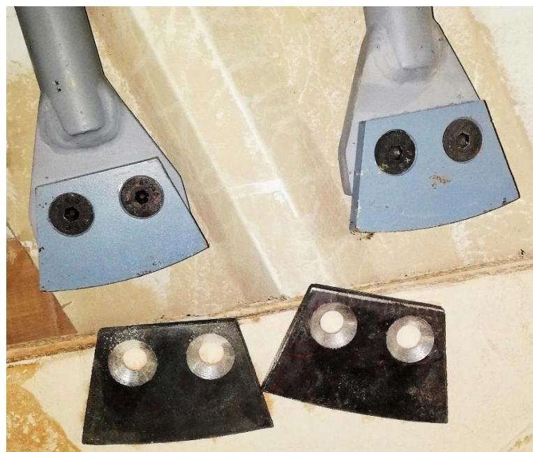
Slika 31. Lopatice homogenizatora (Fotografija: Janješić, 2019.)
