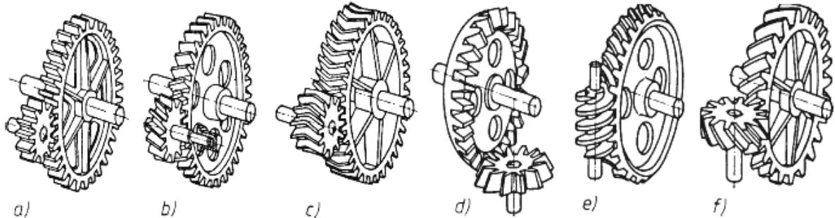
Slika 4. Osnovni oblici spregnutih zupčanih parova (Izvor: Dundžer, 2012.)
