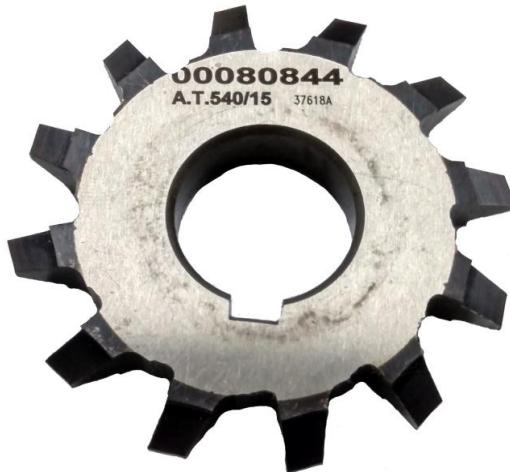
Slika 24. Glodalo za izradu zavoja pužnog vratila (Izvor: autor)
