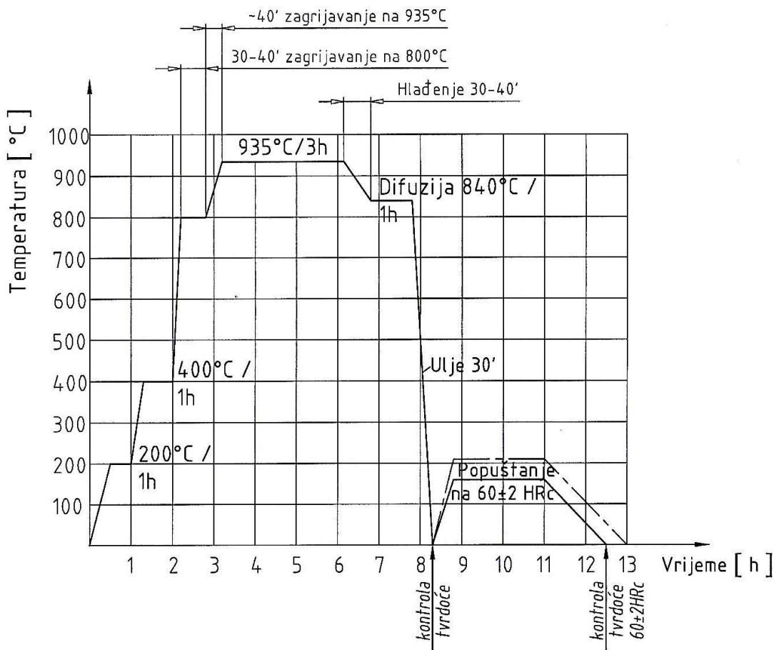
Slika 28. Dijagram toplinske obrade cementacije za materijal Č.4321, tražena tvrdoća  $60\pm 2 \text{ HRC}$  pri dubini od 0,4 - 0,6 mm (Izvor: autor)
