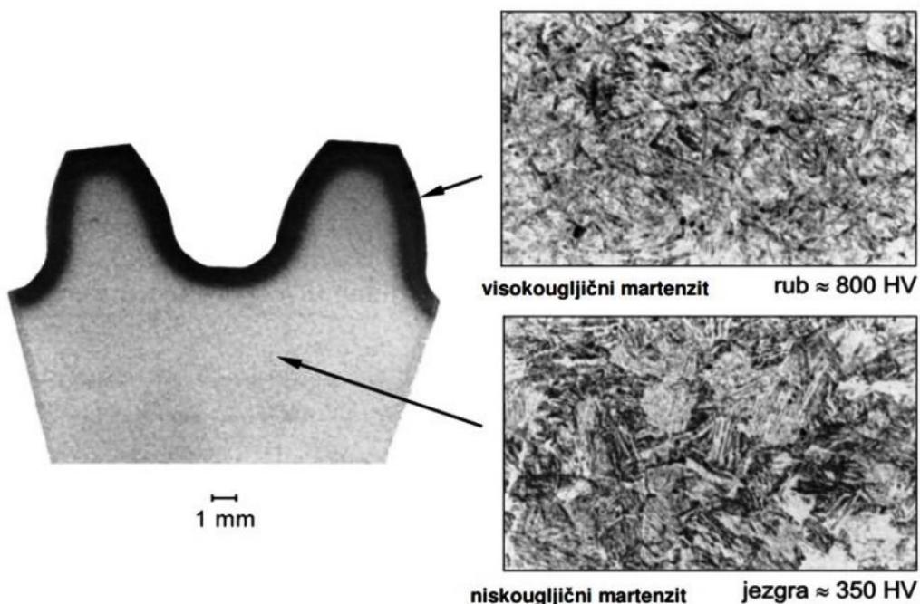
Slika 25. Mikrostruktura cementiranog zupčanika od čelika 16MnCr5 (Č4320)
