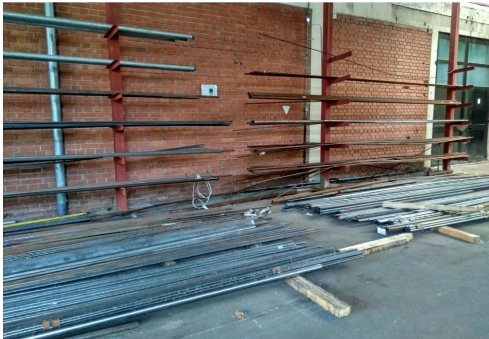
Slika 9. Skladište konstrukcijskih čelika za strojnu obradu (Izvor: autor)
