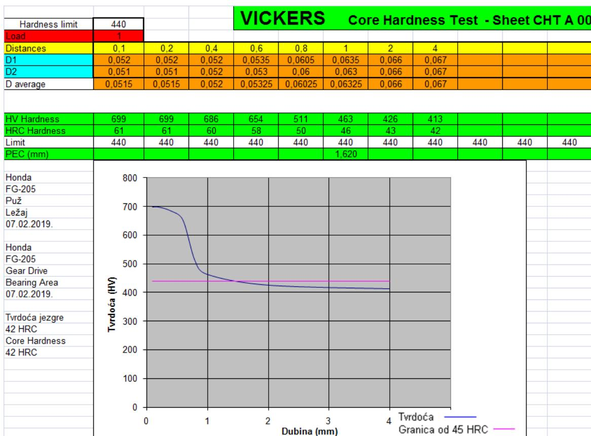
Slika 31. Izvještaj mjerjenja tvrdoće i dubine cementiranog sloja pužnog vratila prema Vickers metodi (Izvor: Autor)
