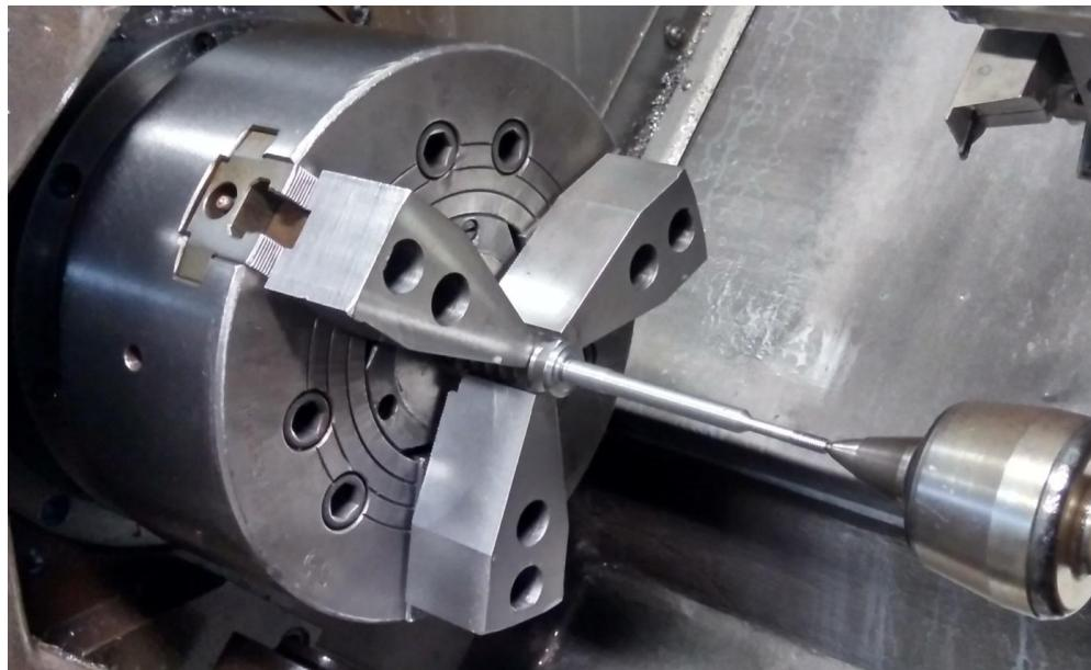
Slika 17. Završno treće tokarenje pužnog vratila. (Izvor: autor)
