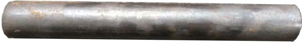
Slika 11. Č.4321 za izradu pužnog vratila izrezan horizontalnom tračnom pilom, promjera Ø25 mm, dužine 192 mm (Izvor: autor)
