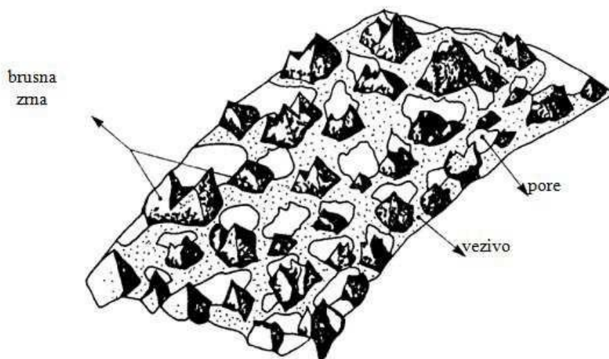
Slika 18. Rezna površina brusne ploče (Izvor: Ciglar, 2018.)
