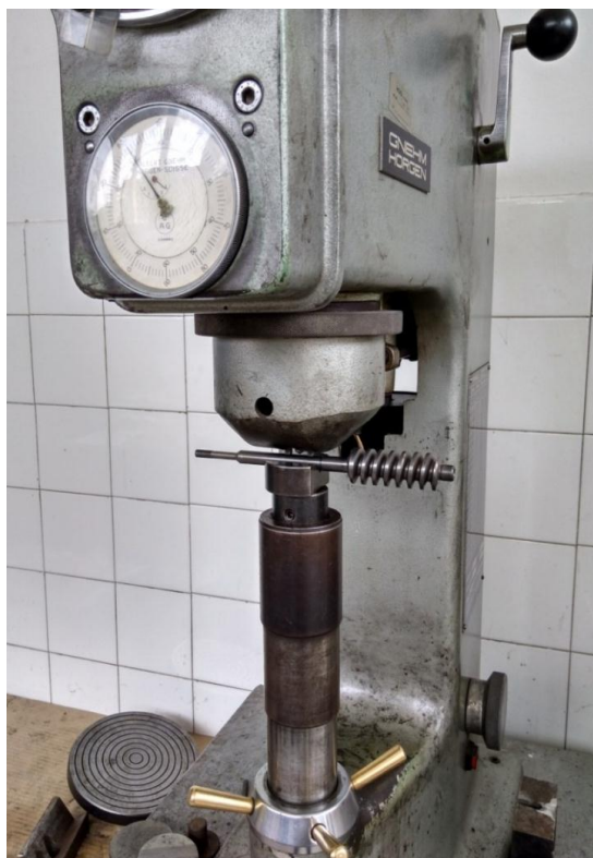
Slika 29. Uređaj za ispitivanje tvrdoće pužnog vratila prema Rockwell metodi (Izvor: autor)
