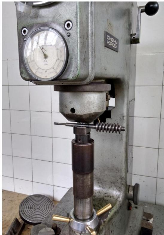
Slika 29. Uredaj za ispitivanje tvrdoće pužnog vratila prema Rockwell metodi
