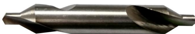
Slika 15. Dvostepeni alat za zabušivanje promjera \varnothing 3,6/\varnothing 7 mm, kut od 60^\circ (Izvor: autor)
