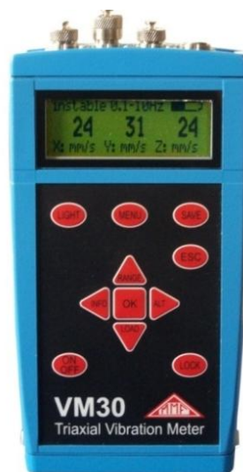
Slika 10. Uređaj za mjerenje vibracija MMF VM30-H (URL3)
