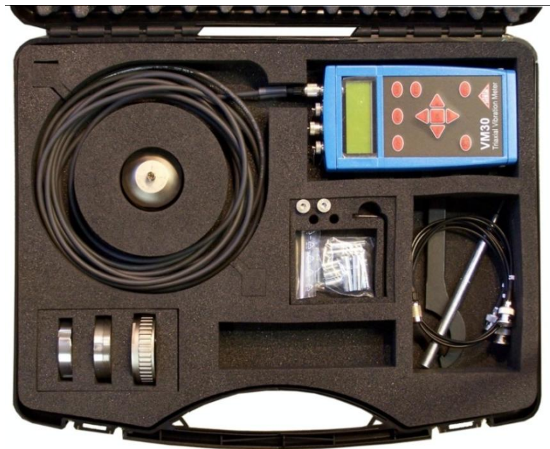
Slika 9. Oprema i uređaj za mjerenje vibracija (URL2)
