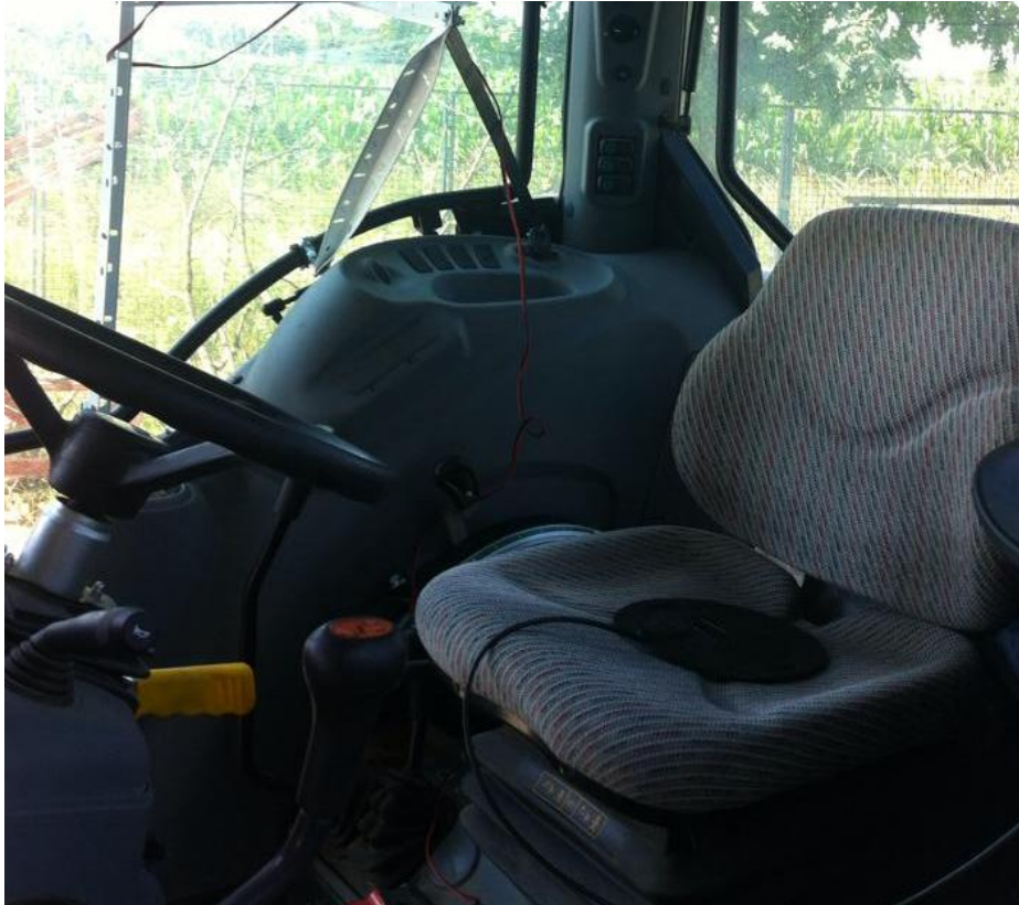
Slika 11. Uređaj za mjerenje vibracija na trup rukovatelja (vlastita fotografija)
