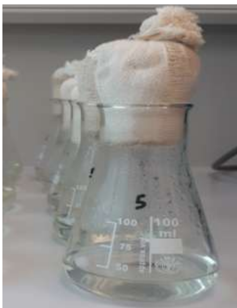
Slika 11. Izgubljena hranjiva podloga isparavanjem bez prisutnosti staklene laboratorijske čaše pri tretmanu od 5 minuta (izvor: Matić)
