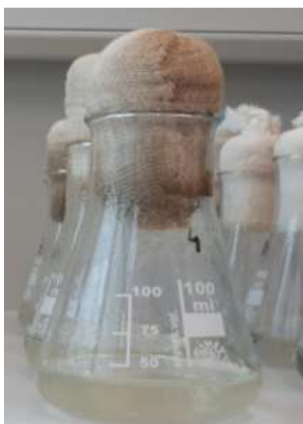
Slika 10. Izgubljena hranjiva podloga isparavanjem bez prisutnosti staklene laboratorijske čaše pri tretmanu od 4 minute (izvor: Matić)
