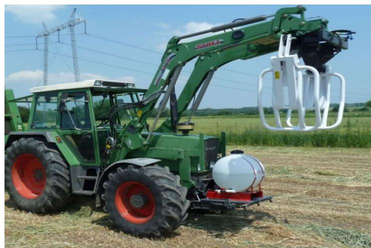
Slika 16 . Traktor FENDT s prednjim utovarivačem (link 8.)
