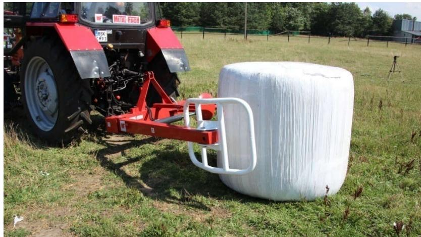
Slika 17. Traktor BELARUS s zadnjim utovarivačem (link 9.)
