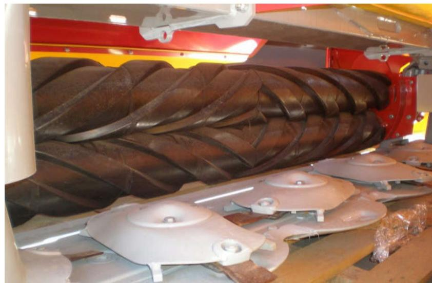
Slika 7. Unutrašnjost kosilice - gnejčilice s valjcima „SIP“ (link 4.)
