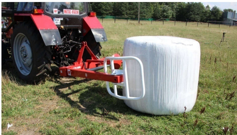
Slika 17. Traktor BELARUS s zadnjim utovarivačem (link 9.)
