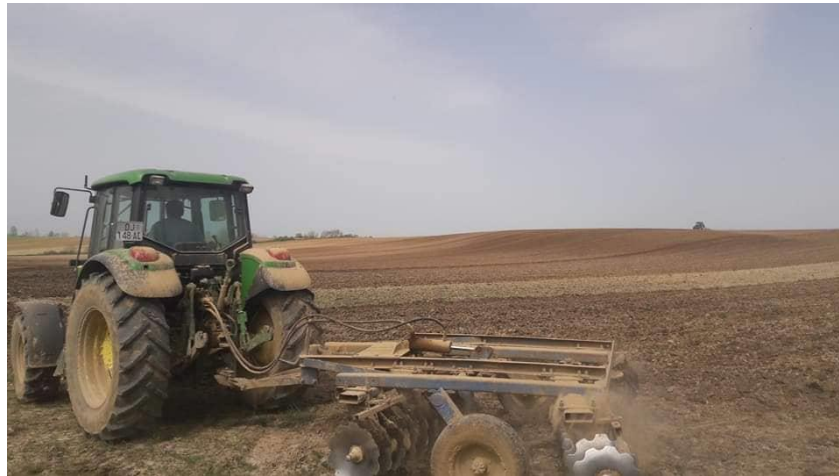
Slika 7. Predsjetvena priprema tla tanjuračom OLT „Tisa“ (Izvor: Ž. Barišić-Jaman)
