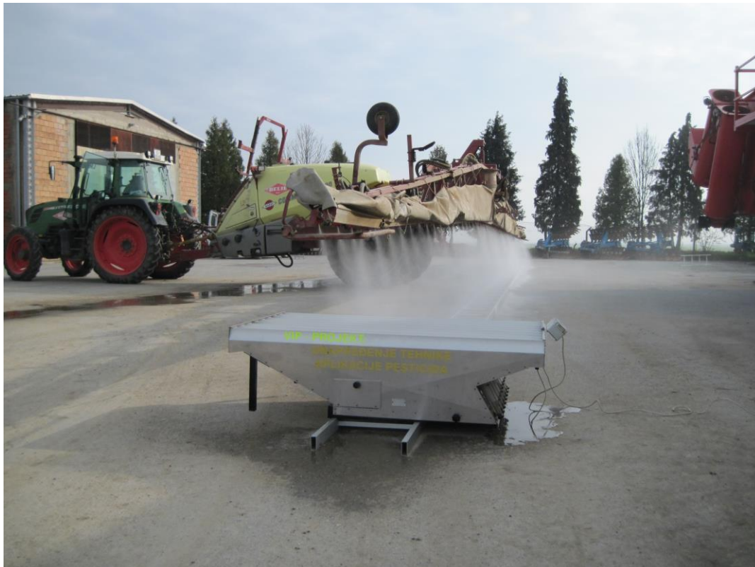
Slika 11. Testiranje poprečne raspodjele tekućine prskalice Hardi Commander L – 214 privatna fotografija (Izvor: foto original M. Glavaš)
