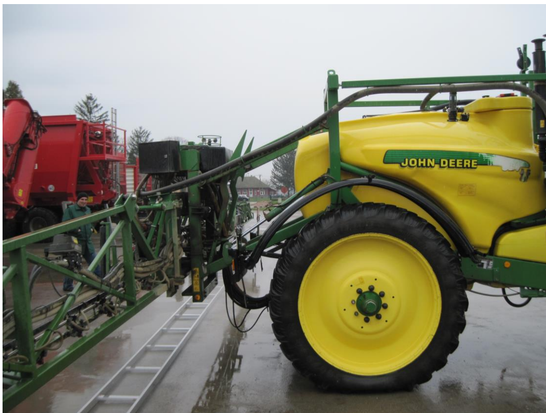
Slika 17. Testiranje površinske raspodjele tekućine na prskalici John Deere 3173 (Izvor: foto original M. Glavaš)
