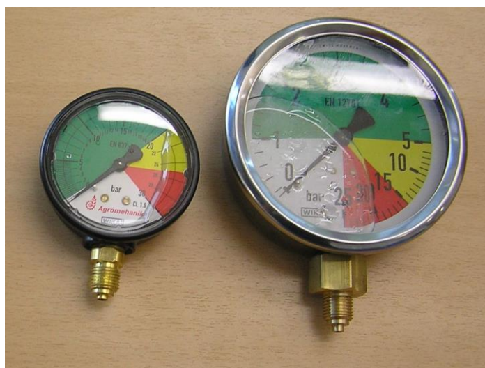
Slika 4. Manometri promjera 63 i 100 mm (Izvor: foto original M. Glavaš)
