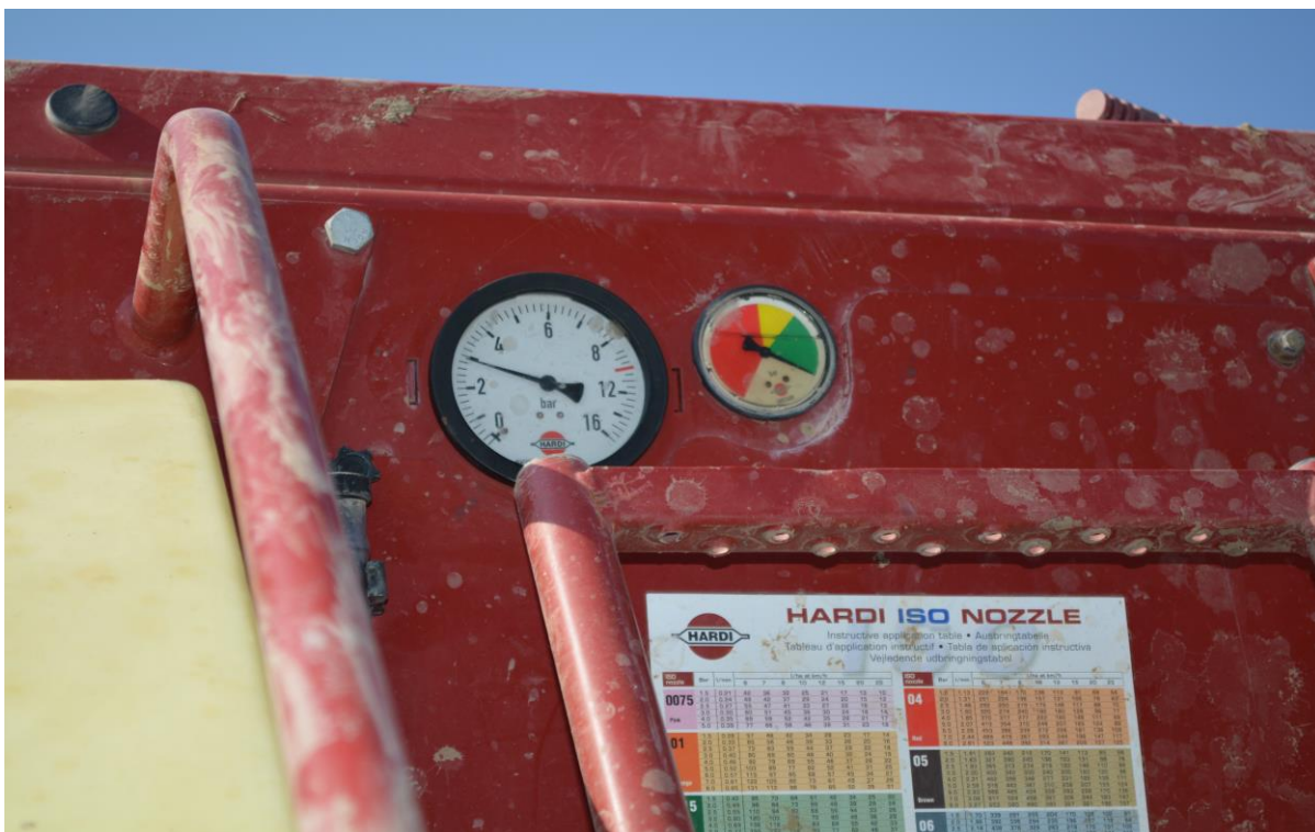
Slika 9. Ispitivani manometar tvrtke Hardi (privatna fotografija)
