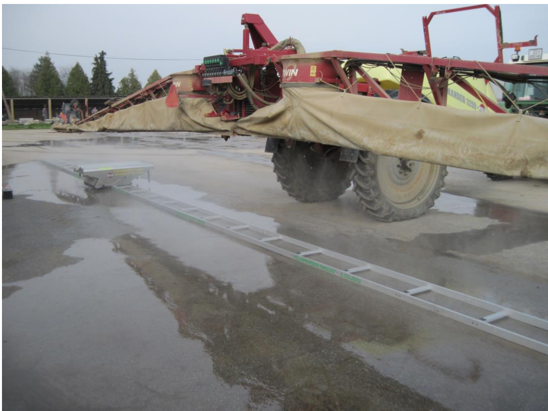
Slika 13. Testiranje raspodjele tekućine pri radu prskalice Hardi Commander L – 215 (Izvor: foto original M. Glavaš)
