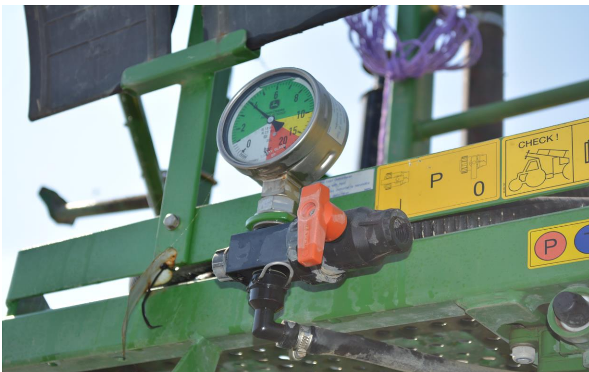
Slika 10. Ispitivani manometar tvrtke John Deere (privatna fotografija)
