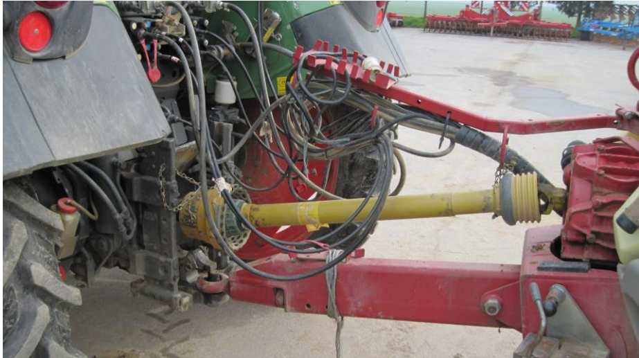
Slika 8. Pravilna zaštita PVT-a na prskalici Hardi Commander (Izvor: foto original M. Glavaš)
