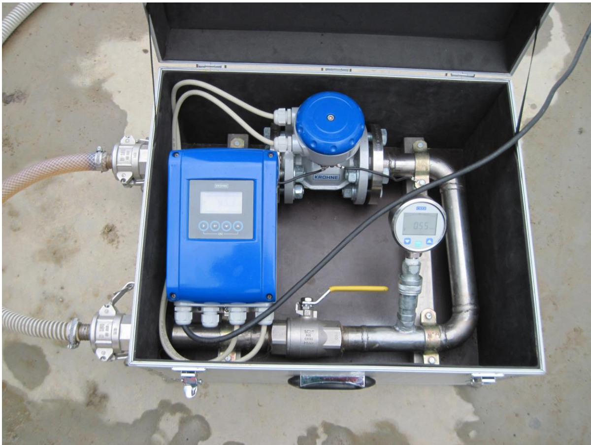
Slika 3. Elektromagnetni mjerач kapaciteta crpke tvrtke Krohne (Izvor: foto original M. Glavaš )
