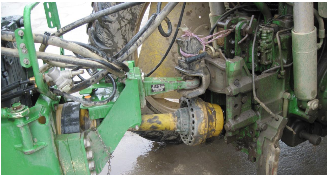
Slika 7. Pravilna zaštita PVT -a na prskalici tvrtke John Deere ( Izvor: foto original M. Glavaš )
