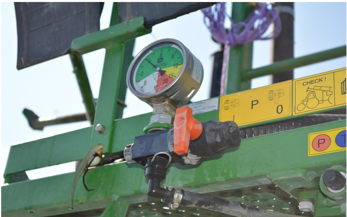
Slika 10. Ispitivani manometar tvrtke John Deere (privatna fotografija)
