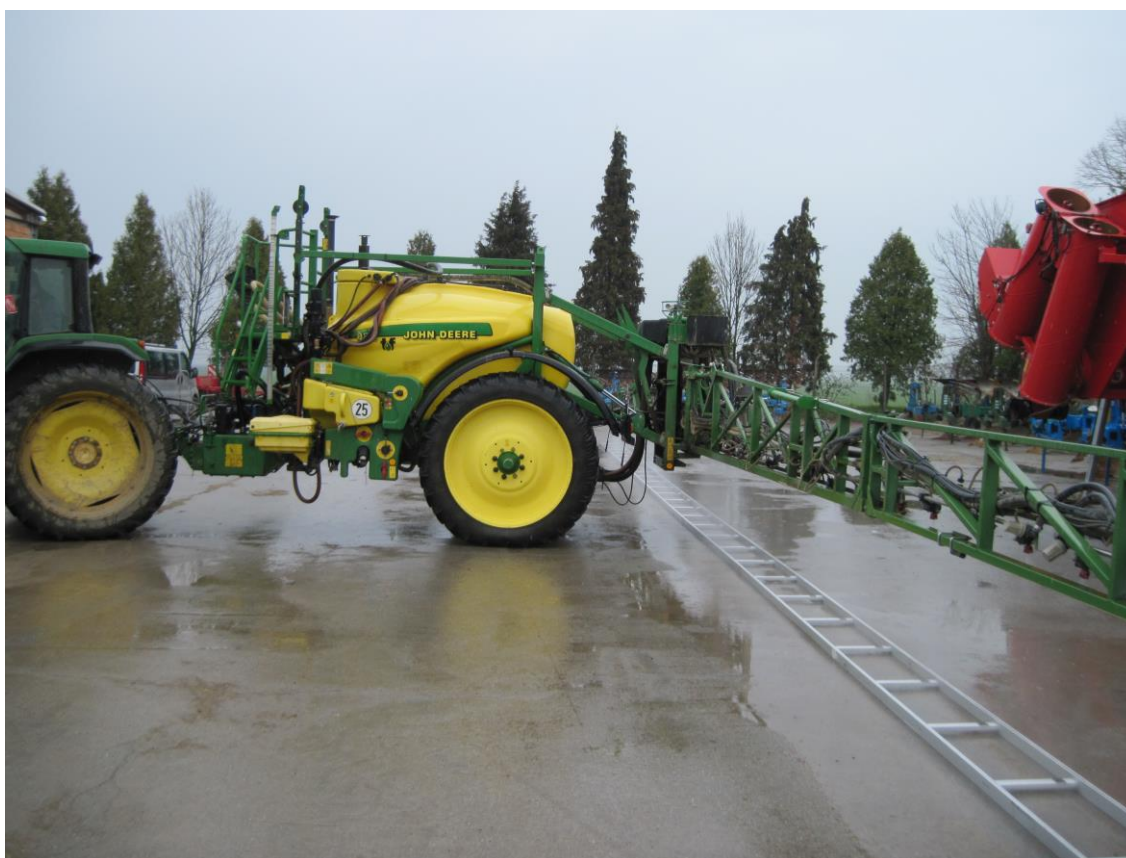
Slika 19. Raspodjela tekućine pri radu prskalice tvrtke John Deere 3172 (Izvor: foto original M. Glavaš )
