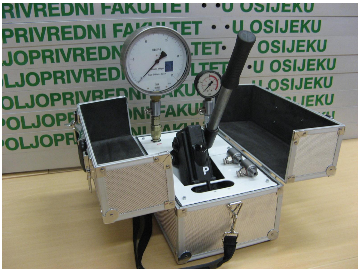
Slika 5. Ispitivanje ispravnosti rada manometra ( Izvor: foto original M.Glavaš )
