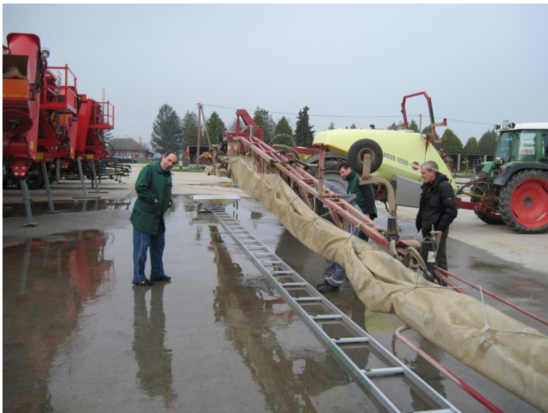
Slika 15. Testiranje površinske raspodjele tekućine na prskalici Hardi Commander L – 336 (Izvor: foto original M.Glavaš)
