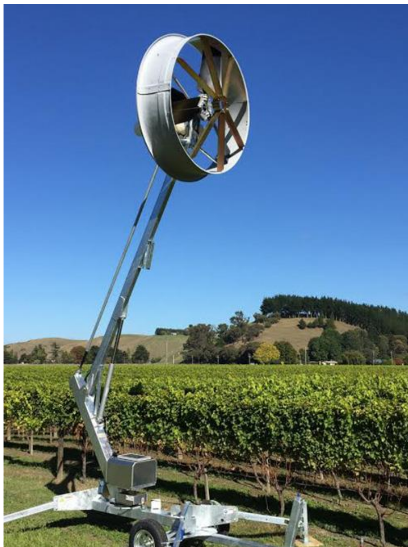
Slika 11. Izvedba ventilatora za stvaranje zračne struje
