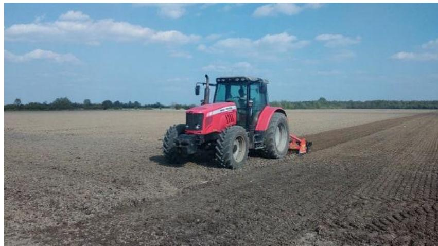
Slika 11. Predsjetvena priprema tla rotacijskom drljačom s packer valjkom u kasno ljetnom roku sjetve lucerne (Foto: M. Brlić)
