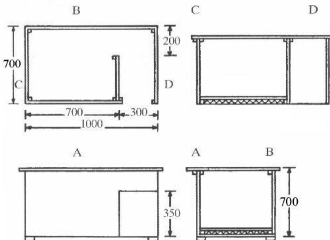
Slika 13. Nacrt, tlocrt i bokocrt kućice za srednje velikog psa
