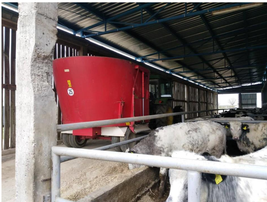
Slika 17. Mikser prikolica za pripremu i raspodjelu obroka u staji
