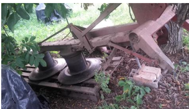
Slika 21. Roto-kosilica za djetelinu
