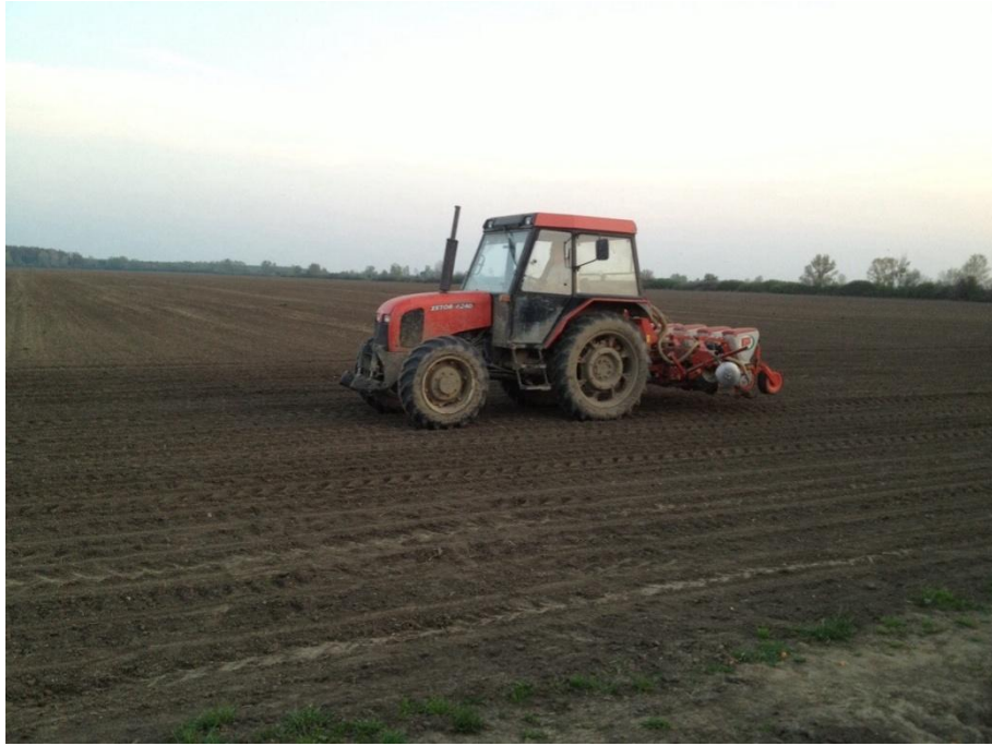
Slika 3. Sjetva soje pneumatskom sijačicom „Gaspardo“ na OPG Marijanović
