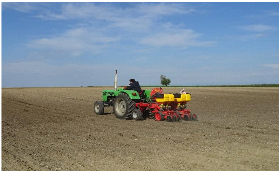
Slika 7. Sjetva MaterMacc sijačicom (Izvor: Banaj, 2016.)
