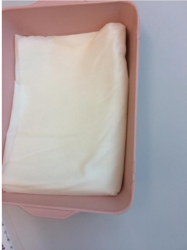
Slika 3. Vlaženje filter papira (izvor: Kraljičak, M.)
