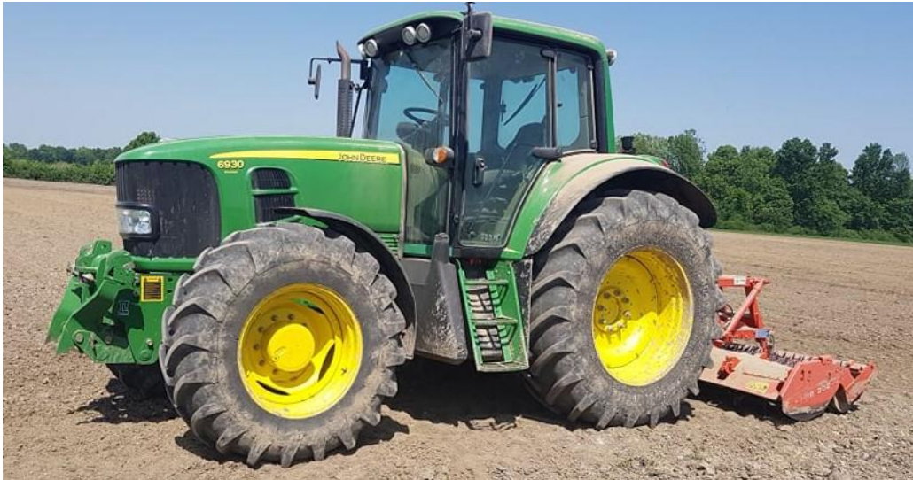
Slika 7. „John Deere 6930 Premium“ i „Kuhn HRB 302“ u predsjetvenoj pripremi tla (Izvor: Marin Kolić)
