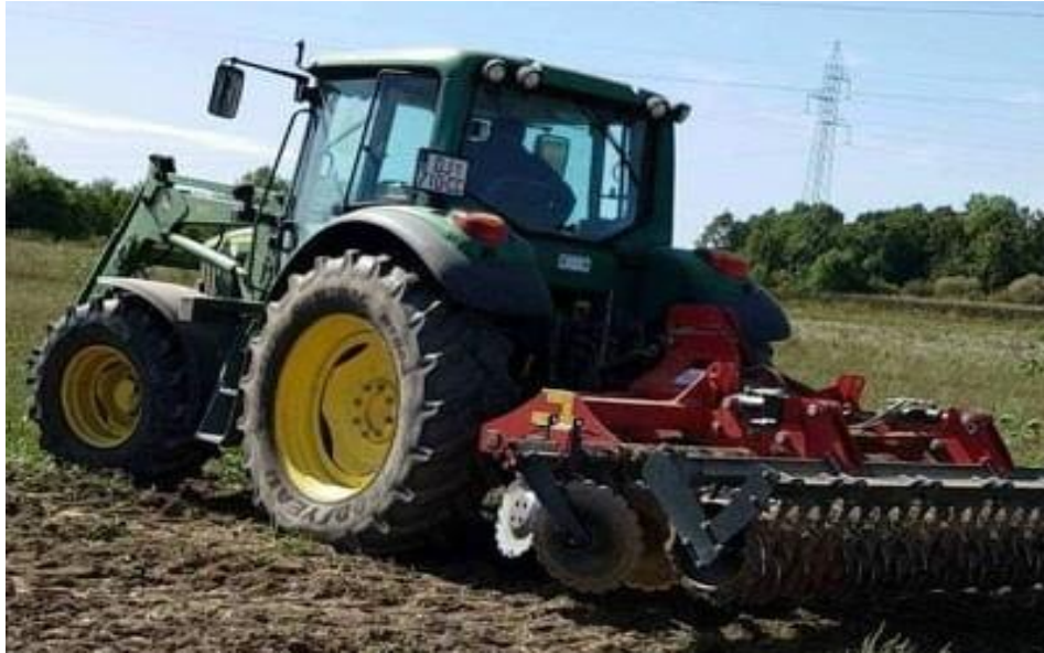
Slika 8. Traktor „John Deere 6420 Premium“ i tanjurača „Metal-Fach 3m“ u predsjetvnoj pripremi tla(Izvor: Marin Kolić)
