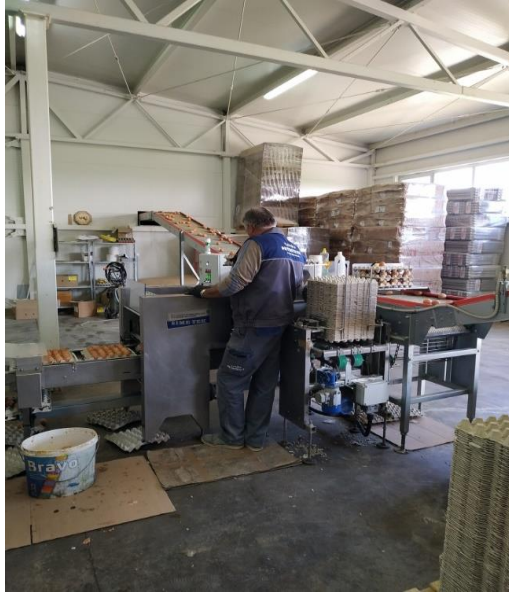
Slika 9. Izdvajanje napuknutih i prljavih jaja (Foto: Martina Kuleš)
