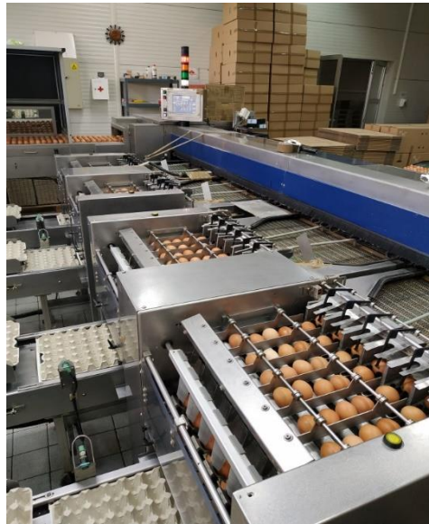
Slika 10. Kalibracijski stroj za sortiranje jaja po težinskim razredima (Foto: Martina Kuleš)
