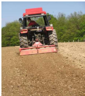
Slika 11. Dopunska obrada tla frezanjem (izvor: https://www.savjetodavna.hr/savjeti/ )
