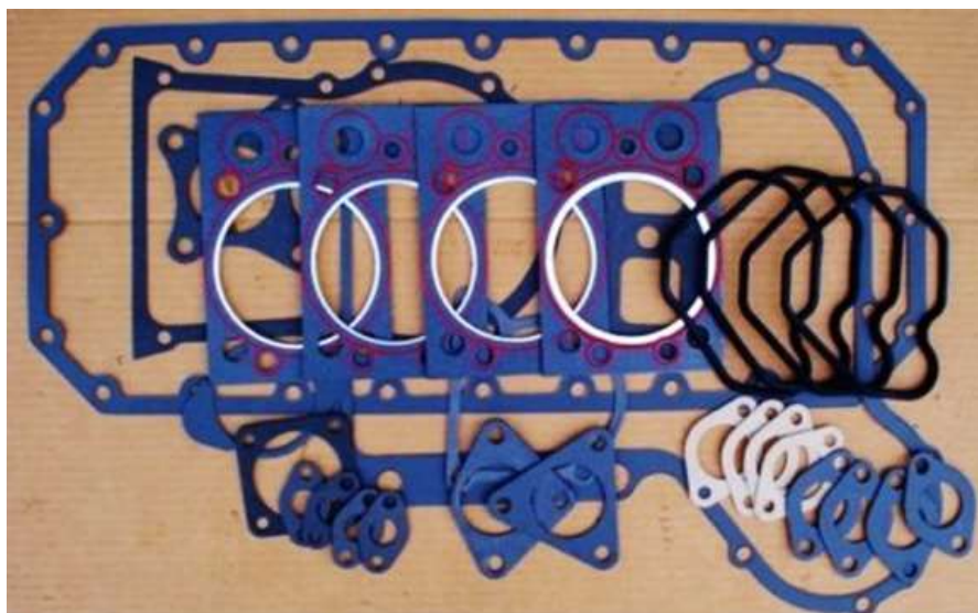
Slika 20. Komplet klingeritnih brtvi za traktorski motor
