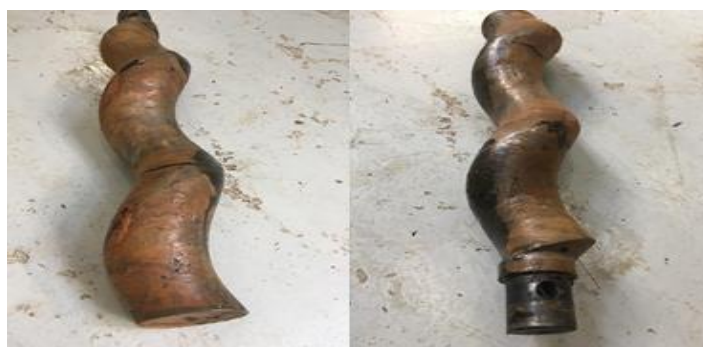
Slika 31. Kavitacijska korozija rotora Biomix crpke
