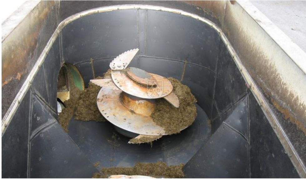
Slika 5. Prikaz korozivnog djelovanja na lopatice mješača
