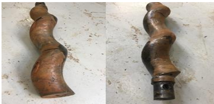
Slika 31. Kavitacijska korozija rotora Biomix crpke
