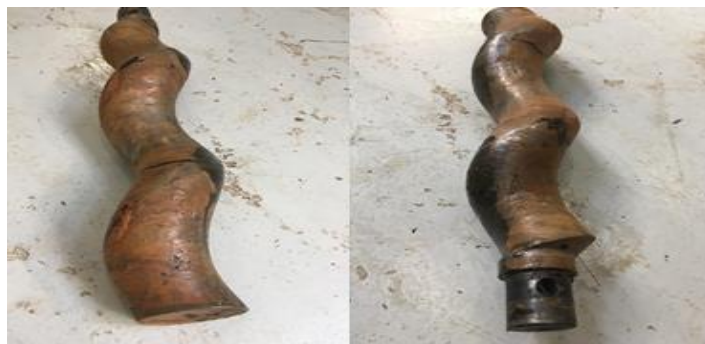
Slika 31. Kavitacijska korozija rotora Biomix crpke
