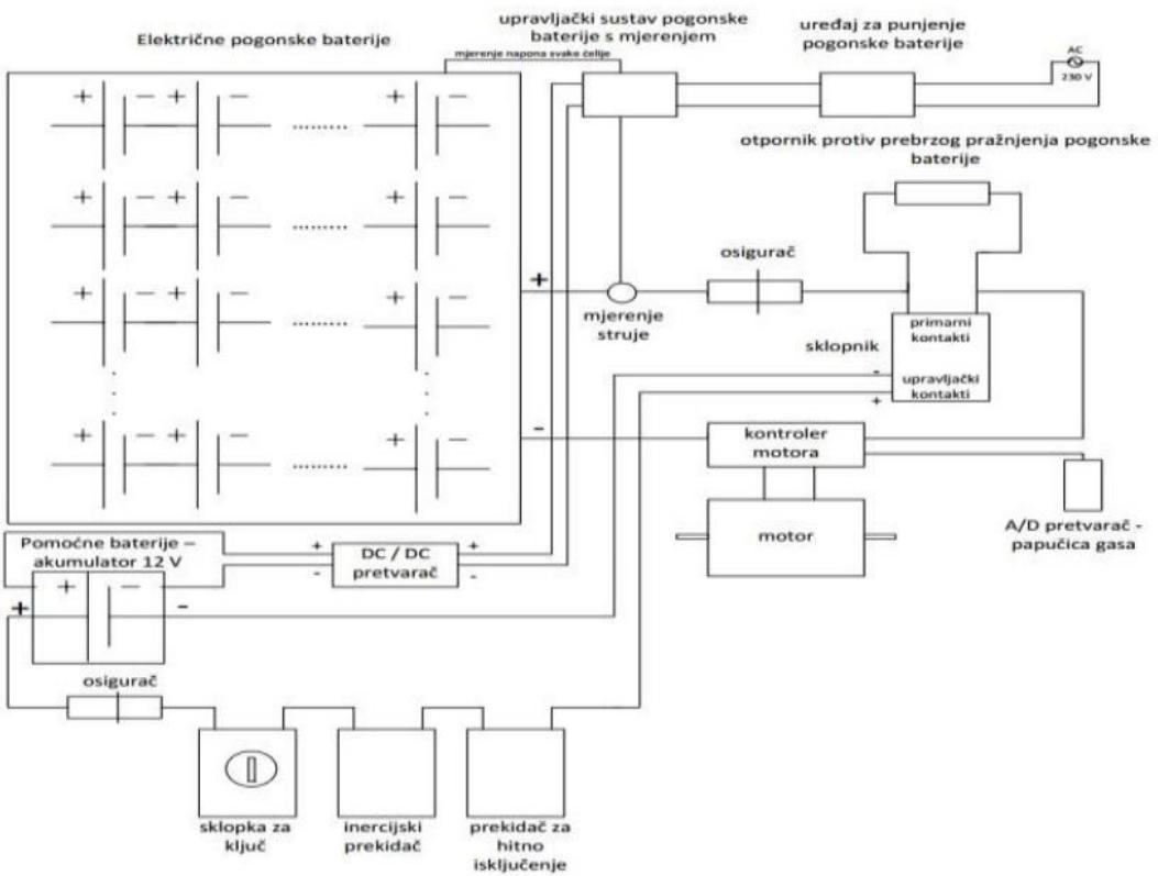
Slika 12: Shema spajanja osnovnih dijelova električnog vozila
