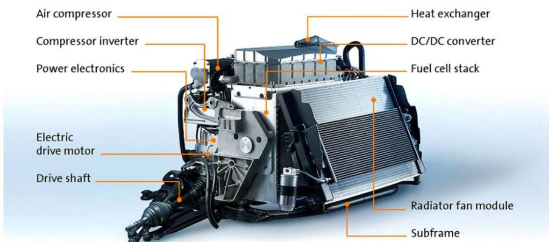
Slika 6: Prikaz pogonskog sklopa na vodikove ćelije
