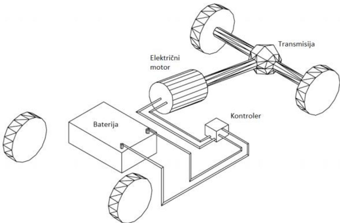
Slika 11: Shema potpuno električnog pogonskog sustava
