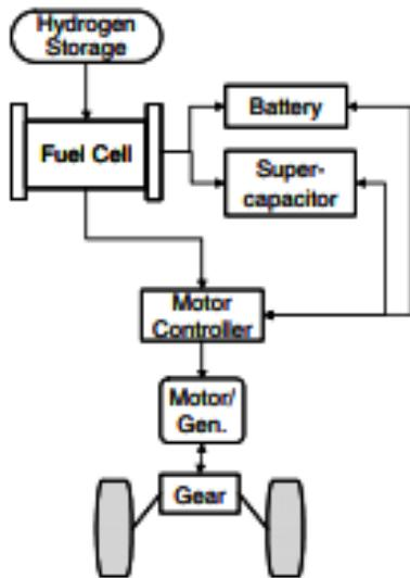
Slika 4: Shema pogonskog sklopa s vodikovim gorivnim čelijama
