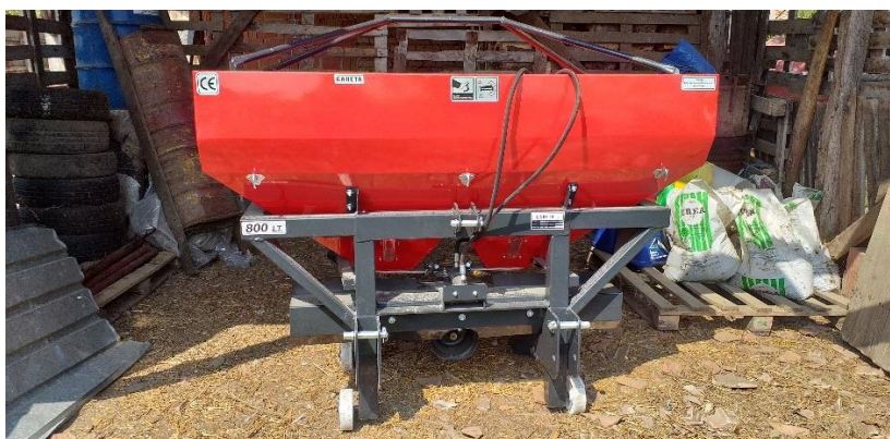
Slika 2. Rasipač mineralnog gnojiva
