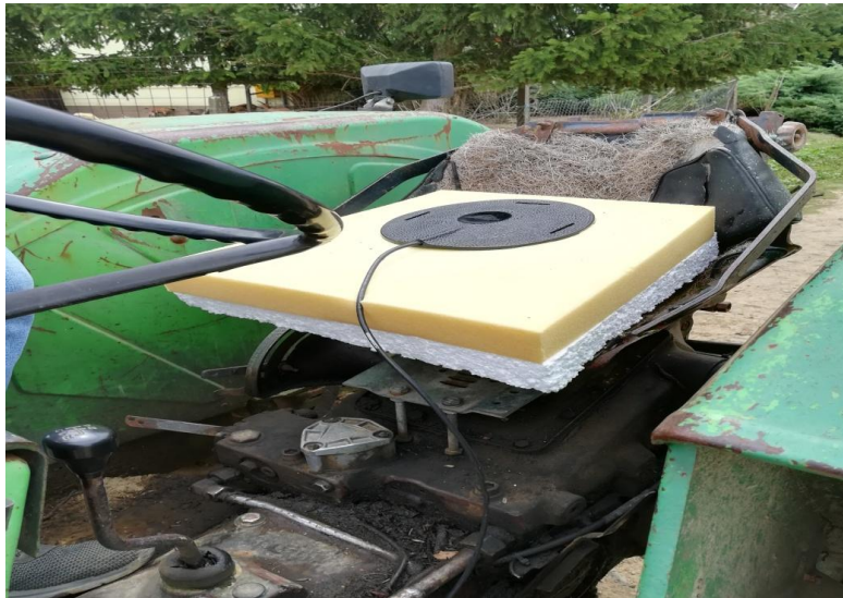
Slika 11: Kombinacija memorijske pjene i stiropora (izvor: Ivan Kamenčak, 2019.)
