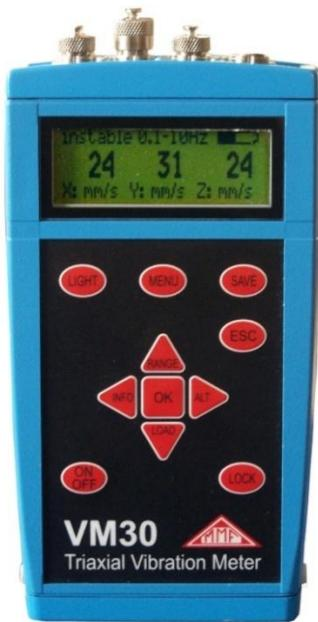
Slika 15. Uređaj za mjerjenje vibracija MMF VM30
